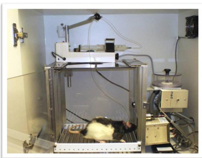
**Figura 9. Sistema de autoadministración intravenosa de drogas (Med-Associates).** Se puede observar la bomba de infusión, el dispensador de bolitas de comida, y la luz que al encenderse hará de estímulo discriminativo. Las palancas en esta imagen se encuentran retraídas.
