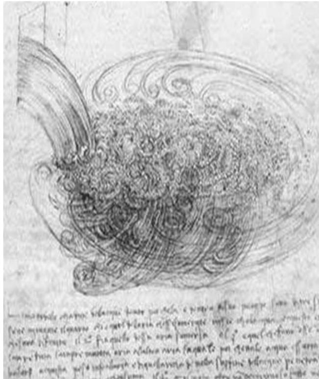
**Ilustración VII.-** “Observad el movimiento de la superficie del agua, que se asemeja al del cabello, que tiene dos movimientos, de los cuales uno es causado por su propio peso y el otro por la dirección de los remolinos; por tanto el agua tiene movimientos rotatorios, una parte de los cuales se debe a la corriente principal, y la otra a un movimiento inverso y aleatorio”. Leonardo da Vinci, 1510.
