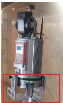
**Figura 3.3:** Soporte sobre el que se monta el escáner.
