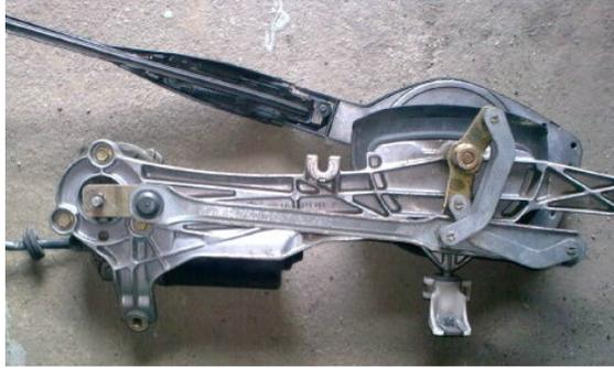
**Figura 5-23. Mecanismo de oscilación sistema limpiaparabrisas**
