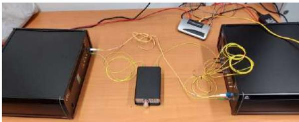
Fig. 4. Sistema QKD en el laboratorio con un atacante en medio del canal cuántico
