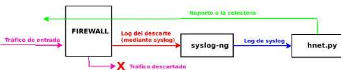
Figura 7. Flujo del tráfico en el sensor
