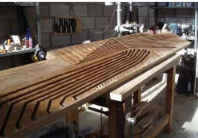
Tablón de conducción antes de ser cubierto con badana y colocado dentro del mueble del órgano.
