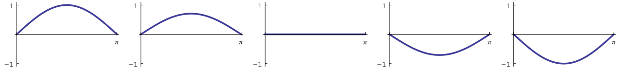
Figura 5.1: Forma de la cuerda en los tiempos t = \frac{k\pi}{4} con k = 0, 1, 2, 3, 4 .
