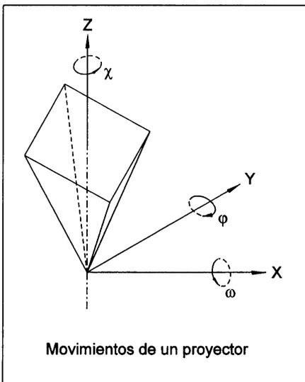
Se puede desplazar paralelamente a sí mismo, según los tres ejes coordenados; desplazamientos en el sentido de las X, de las Y y de las Z, que son tres traslaciones. Con estos desplazamientos lo que hacen es modificar la base estereoscópica entre los dos proyectores del aparato de restitución, se representa respectivamente por  $dbx$ ,  $dby$  y  $dbz$ . En el gráfico se puede ver el sentido que se suele tomar como positivo la traslación en cada uno de los ejes.
