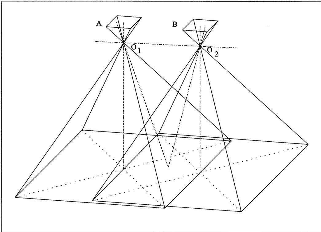
Los rayos de luz que han partido de todos sus puntos de la zona fotografiada han impresionado las placas, formando dos haces perspectivas con centro en las dos posiciones sucesivas del objetivo de la cámara,  $O_1$  y  $O_2$ .
