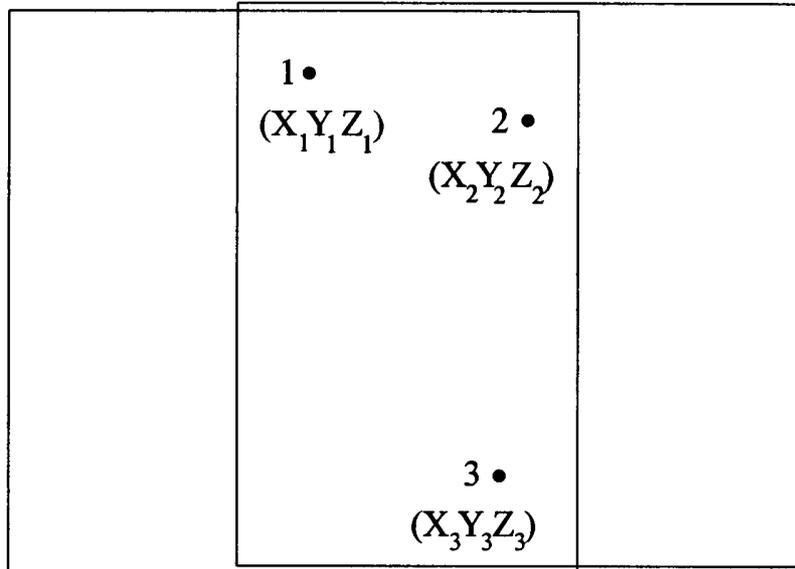
Con la línea 1-3 p.e. del modelo y del plano orientamos bien girando el plano hasta que ambas alineaciones coincidan, o bien girando el conjunto de los dos proyectores.
