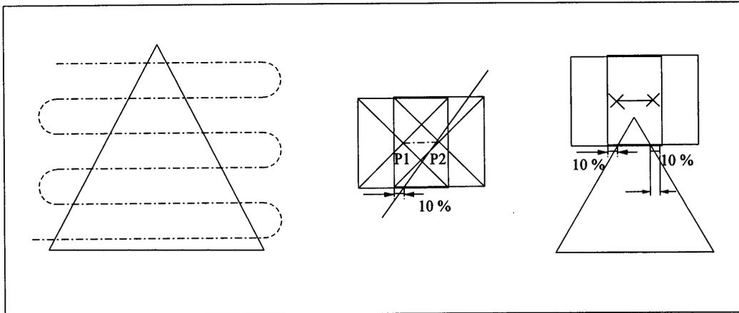
En este caso, con dos fotos basta para obtener el vértice del triángulo.
