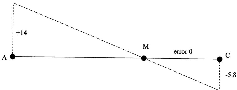
no podemos eliminar la inclinación de golpe con el aparato. Sin embargo, en el aparato tenemos los mandos de  $\varphi$  (inclinación longitudinal) y  $\omega$  (inclinación transversal).
