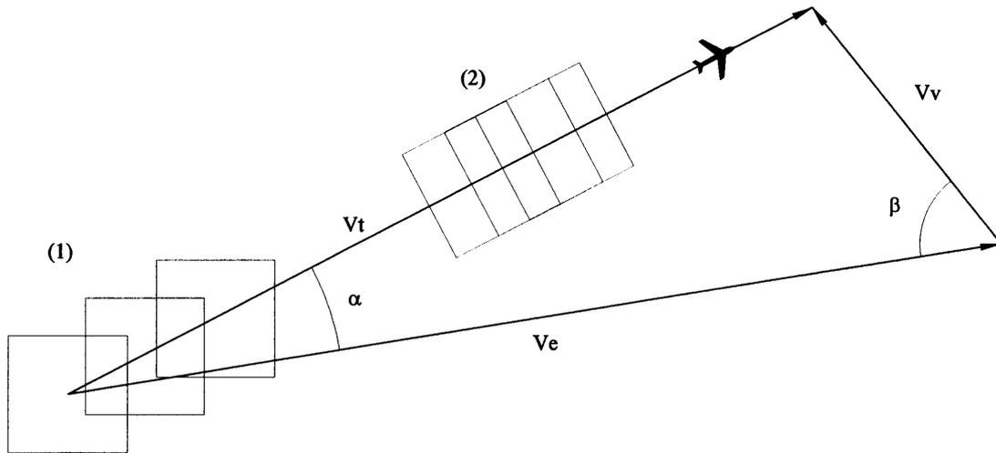
$V_e$  = velocidad del eje del avión respecto del aire
