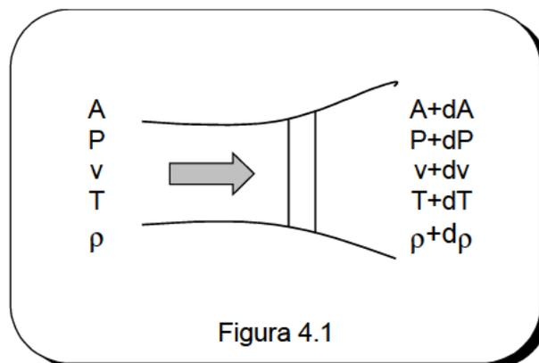
Consideremos dos secciones infinitamente próximas a lo largo del derrame, que suponemos es unidimensional, véase figura 4.1. Sea  $h$  y  $h+dh$  la entalpía y  $v$  y  $v+dv$  la velocidad en cada una de las secciones consideradas. De acuerdo con el Primer Principio se tiene que
