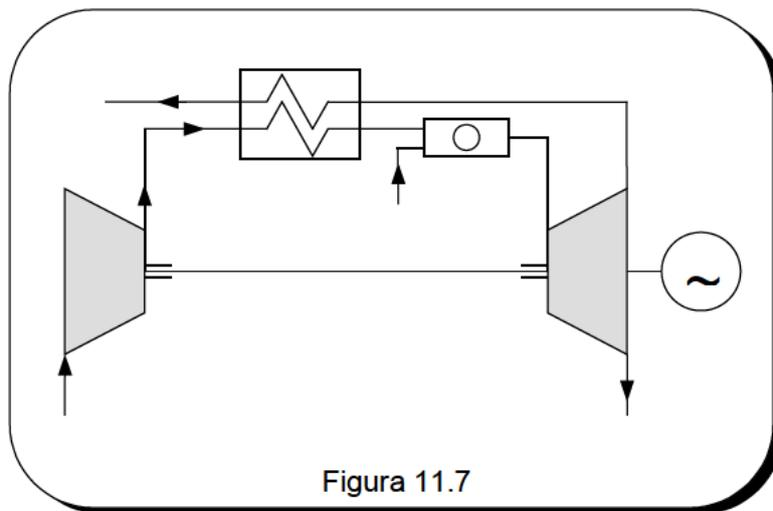
Se define la eficacia del regenerador E como el cociente entre el efecto útil, esto es, el calor cedido al fluido frío ( $h_{2R} - h_2$ ) y el máximo calor que podría haber cedido ( $h_4 - h_2$ ). Por consiguiente
