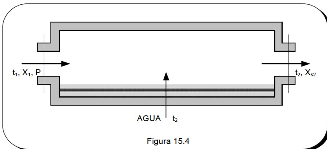
Si la temperatura del agua en la cámara fuera  $t_1$  y si el aire entrara saturado, evidentemente el aire saldría en el mismo estado que el que presenta al entrar en la cámara. Vamos pues a considerar una situación general en que las temperaturas del aire y del agua son diferentes y el aire entra a la cámara no saturado.
