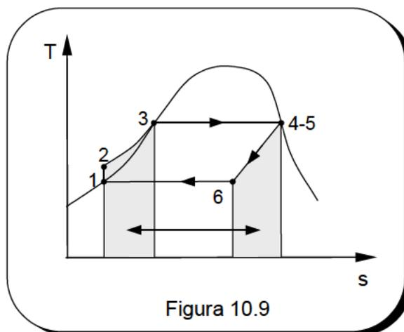
Si para mayor sencillez suponemos un ciclo de Rankine sin recalentamiento, ver figura 10.9, el calor extraído en la expansión de 5-6 lo aportamos al agua en el precalentamiento de 2-3. De esta manera el ciclo obtenido tiene el rendimiento térmico del ciclo de Carnot entre las temperaturas extremas  $T$  y  $T_0$ .
