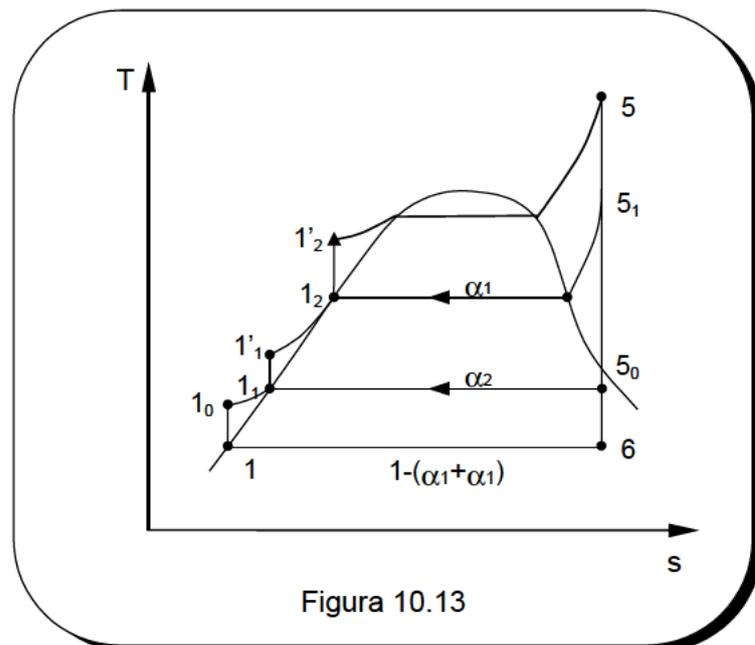
Dado que los estados termodinámicos han sido previamente definidos y se conocen por tanto las entalpías, mediante este sistema de ecuaciones se calculan los valores de  $\alpha_1$  y  $\alpha_2$ . Siendo  $\dot{m}$  el gasto de vapor de admisión, la potencia de la instalación será
