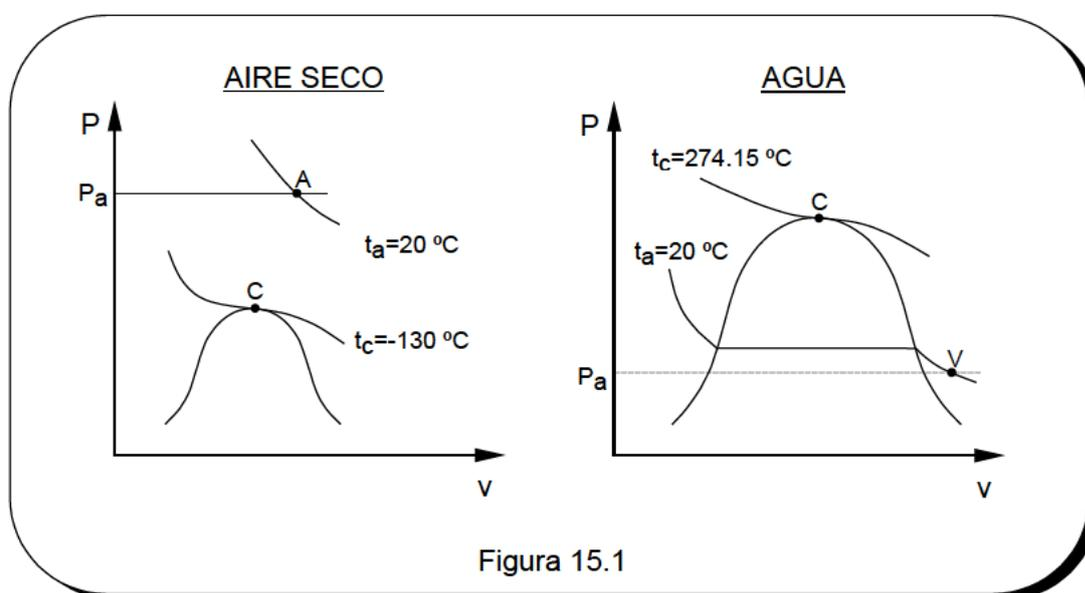
El segundo diagrama P-v se refiere al agua y en él se representa la isoterma de  $20^\circ\text{C}$  y un estado V del vapor, ligeramente recalentado. Como se observa, las temperaturas ambientales típicas se encuentran muy por debajo de la temperatura crítica del agua, de forma que un pequeño aumento de la presión bastaría para producir la condensación.
