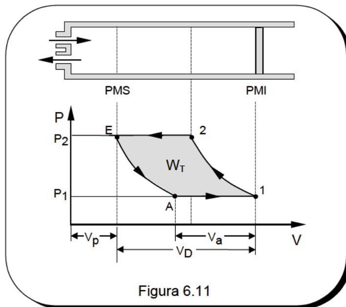
Como consecuencia del espacio perjudicial, el volumen aspirado por el compresor es  $V_a$ , evidentemente menor que el volumen desplazado  $V_D$ . Para poder valorar el caudal manejado por un compresor se define el **rendimiento volumétrico**,  $\eta_v$ , como la relación entre ambos volúmenes
