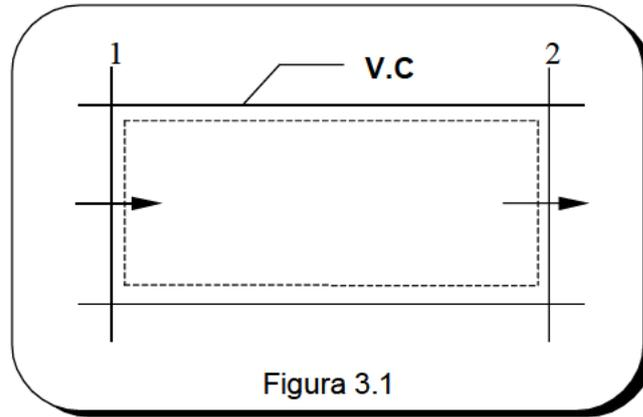
En régimen estacionario, el gasto que pasa por la sección 1 es evidentemente el mismo que en 2. Admitida la hipótesis de flujo unidimensional en las secciones 1 y 2 y puesto que no existe trabajo técnico intercambiado, de la ecuación (2.31) se tiene
