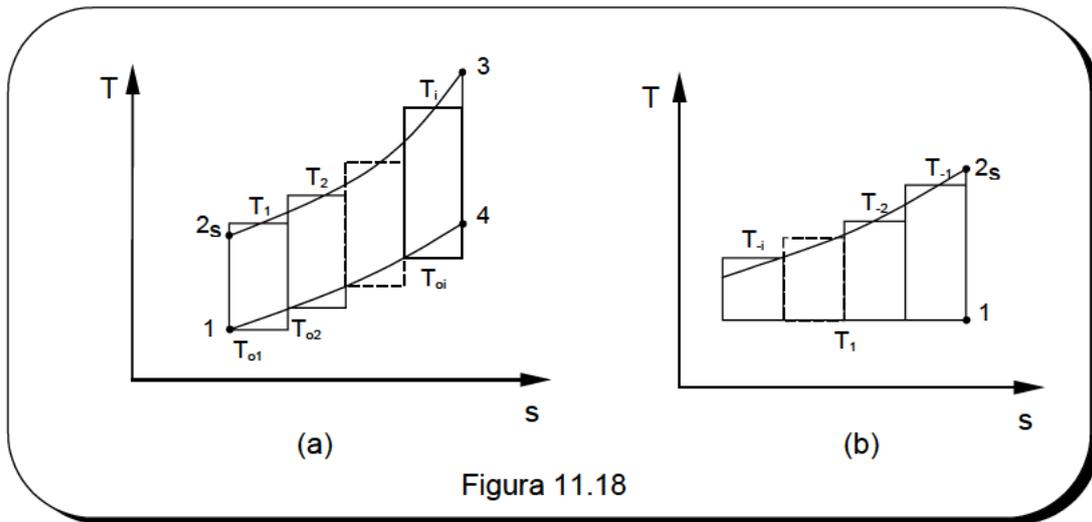
El ciclo de compresión isoterma, al tener una temperatura de salida del compresor  $T_1$  más baja se presta a la regeneración.
