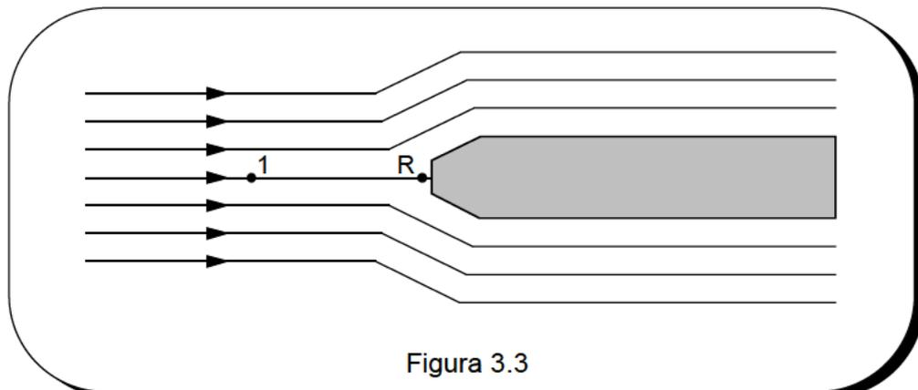
Consideremos en primer lugar un proceso de derrame en el que las líneas de corriente (coincidentes con las trayectorias, pues nos estamos refiriendo en todo momento a régimen estacionario) son las que se dibujan en la figura 3.3. Elijamos dos puntos de una línea de corriente: el punto 1 y el de remanso R. Aplicando la ecuación de Bernoulli entre ambos, podemos escribir
