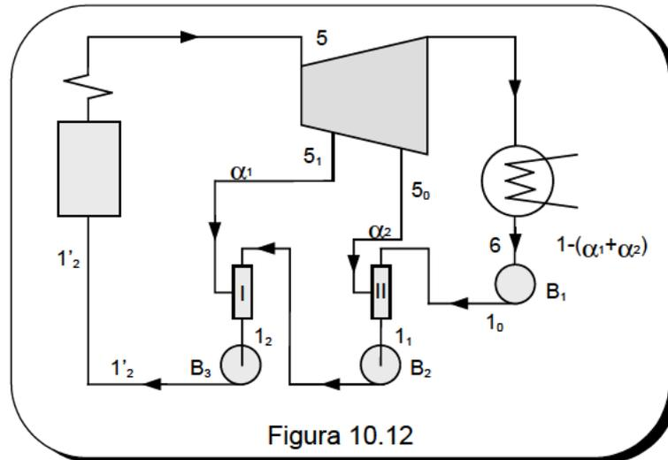
Por cada kg de vapor admitido en la turbina extraemos  $\alpha_1$  y  $\alpha_2$  kg respectivamente en la primera y segunda extracciones. Siendo los estados a la entrada y salida de los precalentadores los que aparecen representados en el diagrama T-s de la figura 10.13, haciendo los correspondientes balances de energía se tiene
