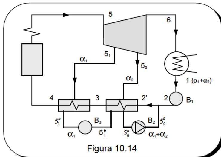
El ciclo descrito se representa en el diagrama T-s de la figura 10.15. El vapor de la primera extracción se lleva al primer precalentador donde se condensa, estado  $5_1^a$ . Dicho vapor se expande en una válvula de orificio hasta la presión del primer precalentador, proceso isoentálpico desde el estado  $5_1^a$  al estado  $5_1^b$ .
