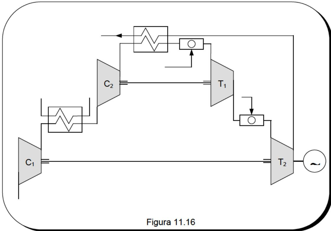
El esquema dibujado corresponde a un montaje de doble eje. Ello impone unas restricciones a los saltos de presión, ya que en este esquema la turbina de alta  $T_1$  ha de accionar al compresor de alta  $C_2$ , por lo que una de las presiones intermedias, la de compresión o la de expansión, no se puede fijar por mínimo trabajo de compresión o máximo de expansión.
