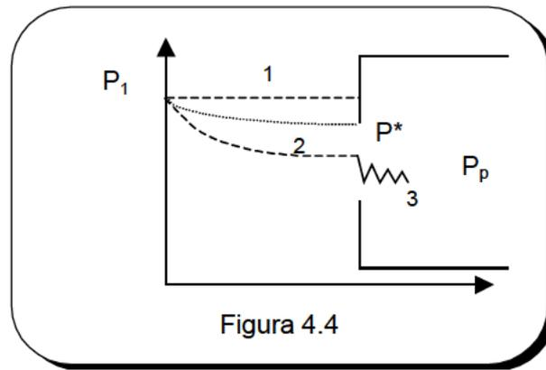
Conforme la contrapresión disminuye, aumenta el gasto; además, el número de Mach va aumentando también a lo largo del derrame. Cuando  $P_p$  alcanza el valor de la presión crítica de la tobera  $P^*$ , en la sección de salida o garganta de la tobera la velocidad del fluido coincide con la del sonido. Esta situación se representa por la línea 2 y corresponde a la operación de la tobera en las condiciones de diseño.
