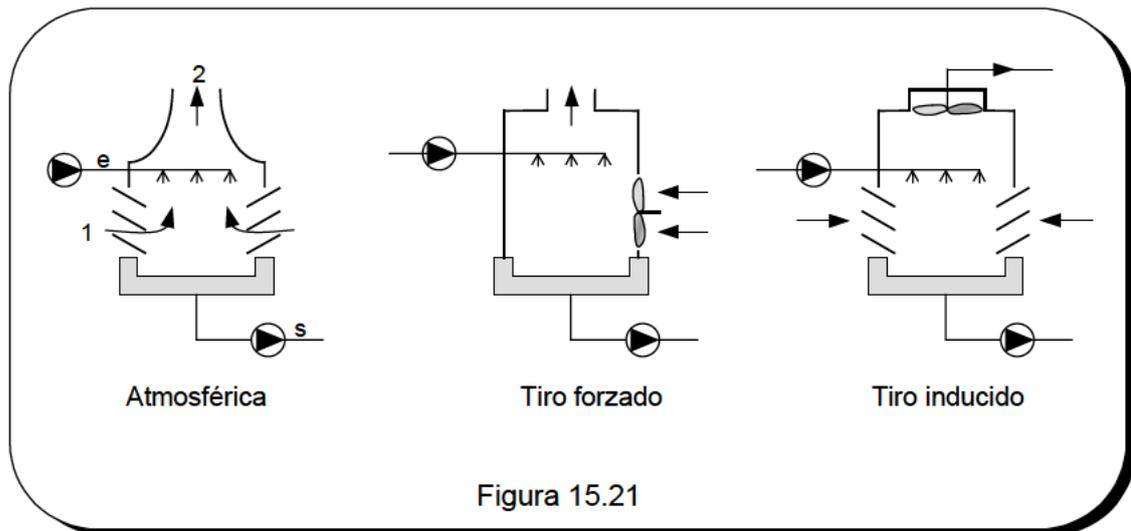
Debido a la evaporación parte del agua se pierde a la atmósfera, por lo que se requiere la aportación de agua de reposición. Refiriéndonos a uno cualquiera de los tres tipos de torre de la figura 15.21, si llamamos 1 y 2 los estados de aire a la entrada y salida y e, s las del agua a enfriar, haciendo un balance de masa para el agua se tiene
