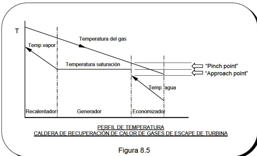
Cuanto mas pequeño es el pinch point mayor debe ser la superficie de intercambio y en consecuencia, el peso y coste de la caldera. Por el contrario, un pinch point elevado implica mayor salto térmico en el evaporador y recalentador, pero también mayor temperatura de salida de los gases .
