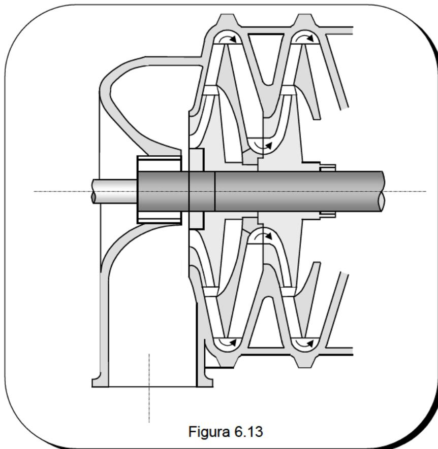
El rodete es el órgano más importante del compresor. Se construye según uno de los cuatro tipos siguientes: abierto (a), cuando los álabes se fijan al cubo del rodete; semiabiertos (b), si los álabes se fijan a un solo disco; de doble aspiración (c), y de
