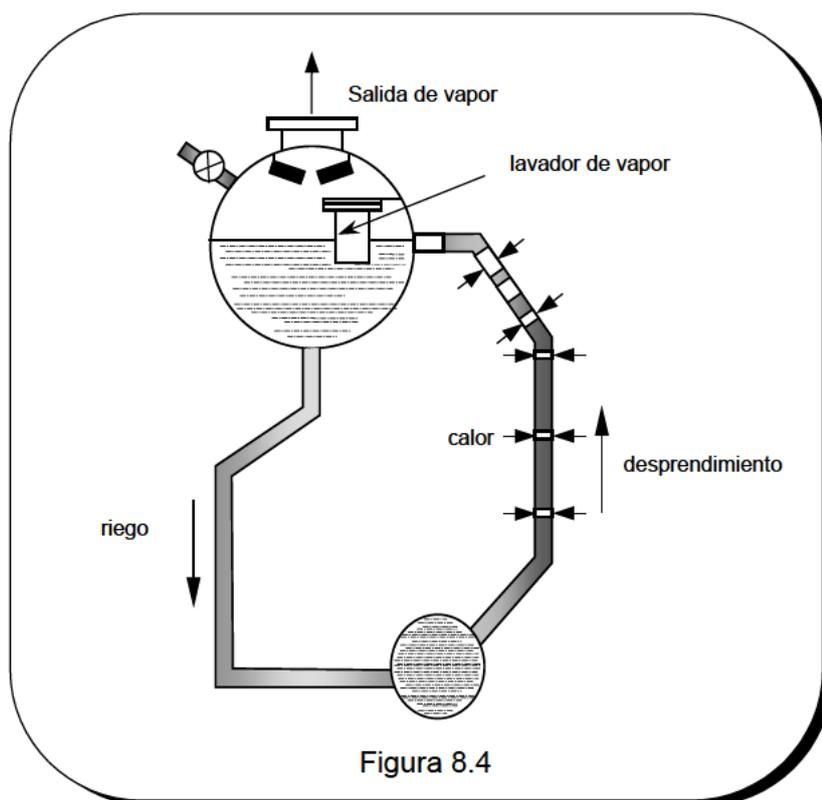
En los tubos de bajada el agua se encuentra a la temperatura de saturación o un poco inferior. Los tubos de subida están expuestos al calor radiante directo de la llama y en ellos se produce la vaporización. La densidad menor del vapor húmedo en los tubos de subida proporciona el empuje que mantiene la circulación.
