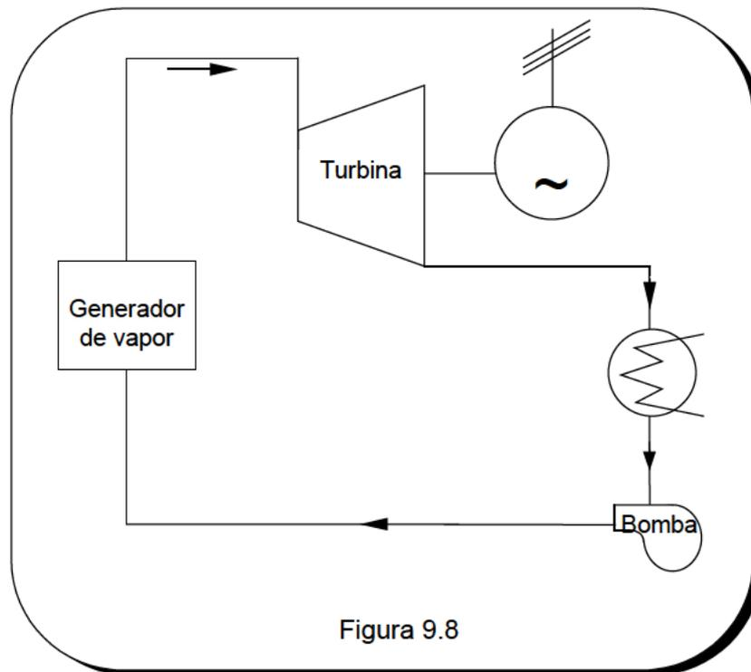
El vapor que sale del generador entra en una turbina donde se expande hasta la presión de condensación, estado 4. Finalmente, dicho vapor pasa por un intercambiador condensador, donde mediante agua de refrigeración se consigue condensar hasta volver nuevamente al estado inicial de vapor húmedo 1.
