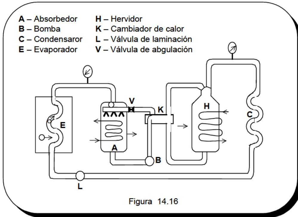
Los elementos fundamentales del ciclo, absorbedor, evaporador, hervidor, condensador, válvula de laminación, bomba de circulación, cambiador de calor y válvula de regulación, realizan las funciones que describimos a continuación.
