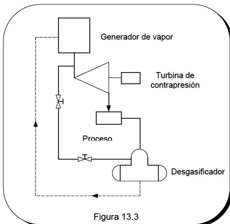
El vapor entra a la turbina en el estado correspondiente a la salida del generador y sale en las condiciones demandadas por el proceso. La entalpía de vaporización, que se perdería normalmente en el condensador de un ciclo de potencia clásico, es aprovechada en el proceso, resultando con ello un importante aumento del rendimiento global de la instalación.
