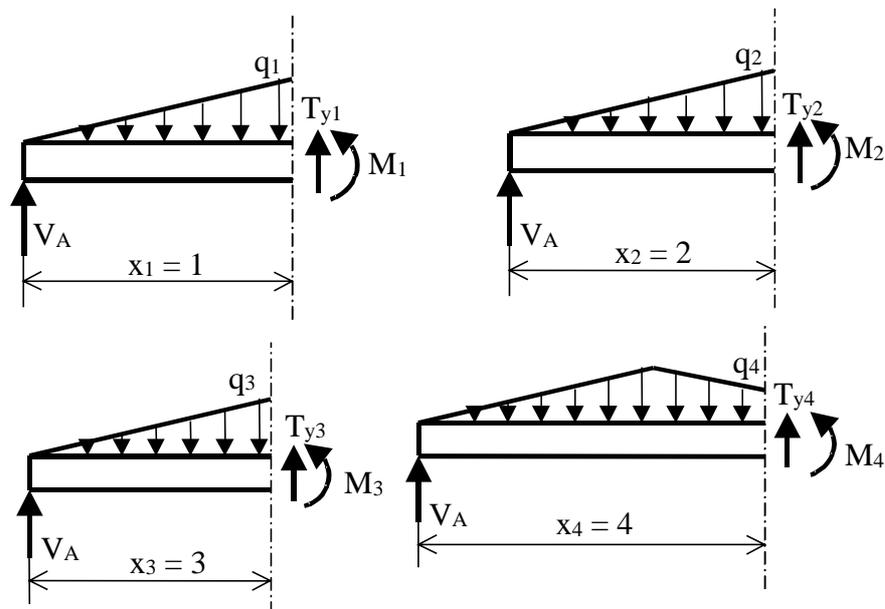
Figura 2.2d Método de las secciones en la viga
