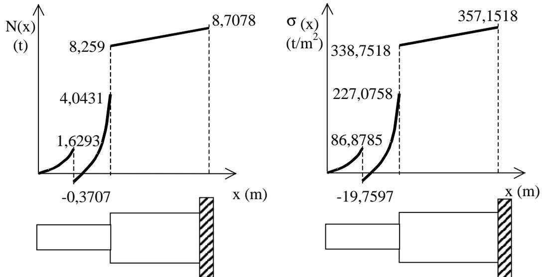
Figura 6.10b Diagramas de esfuerzos y de tensiones normales
