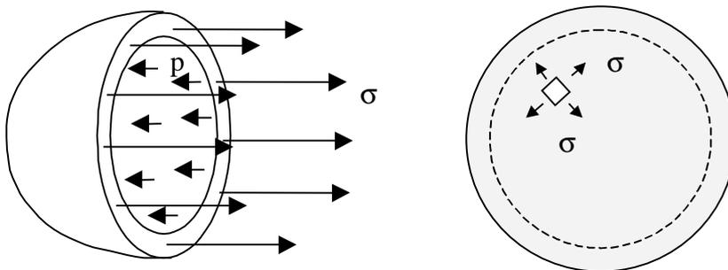
Figura 15.9 Tensión en un recipiente esférico a presión
