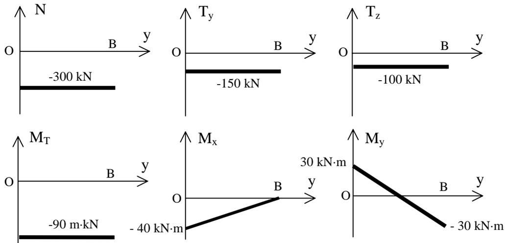
Figura 14.1b Diagramas de esfuerzos según los ejes absolutos
