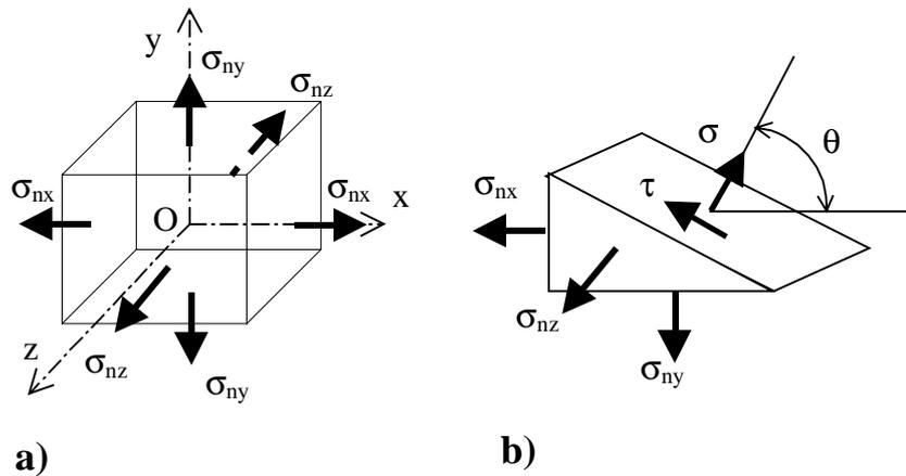
Figura 15.13 Elemento en estado de tensión triaxial
