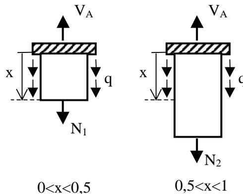
Figura 6.5b. Método de las secciones
