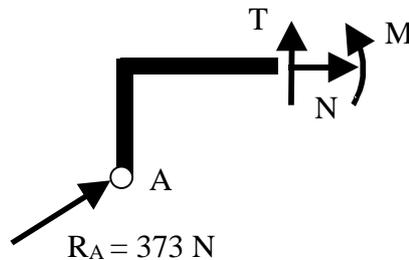
Figura 2.5b Método de las Secciones
