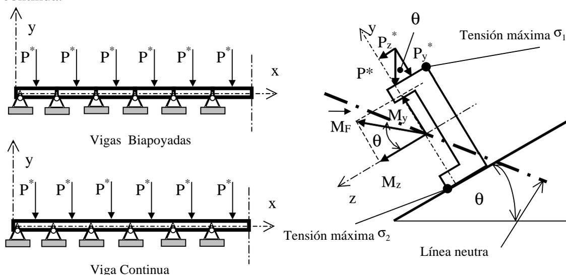
Figura 10.2 Correa con carga puntual que produce flexión desviada.
