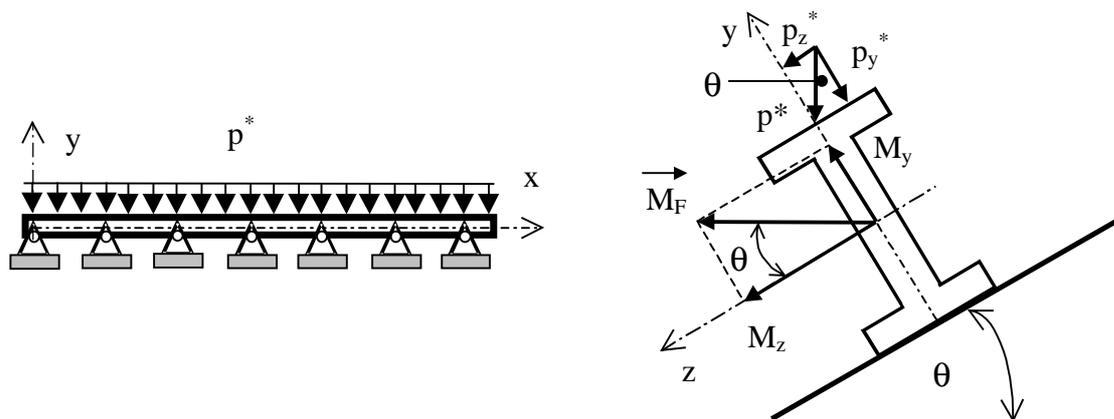
Figura 10.1a Correa con carga uniforme que produce flexión desviada.
