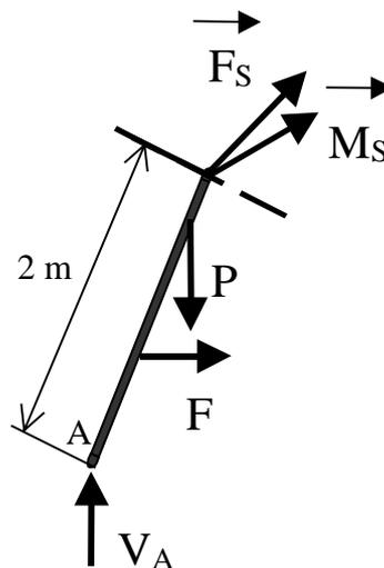
Figura 2.4b Método de las Secciones
