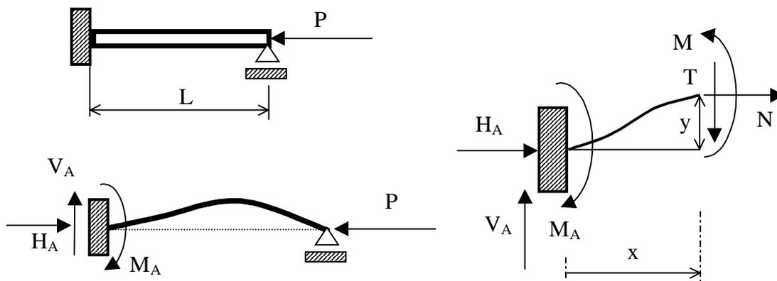
Figura 11.1a Viga comprimida empotrada-apoyo móvil.
