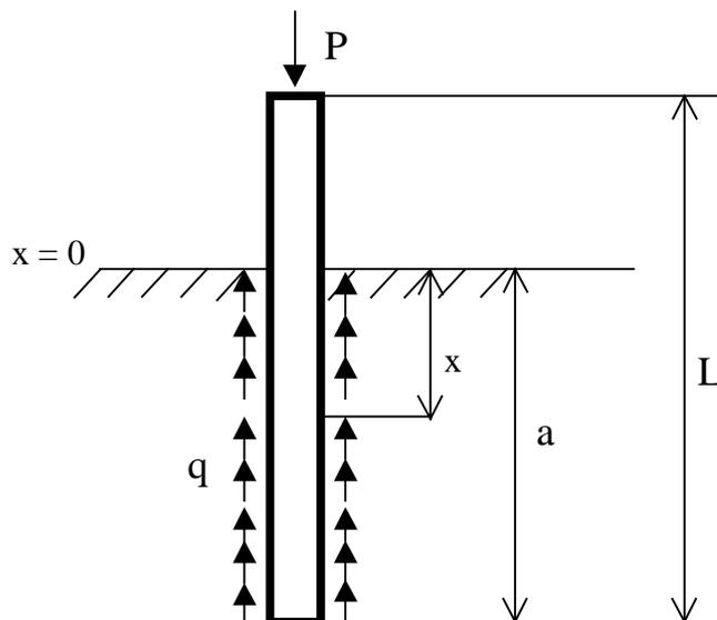
Figura 6.2a Estaca anclada en el terreno
