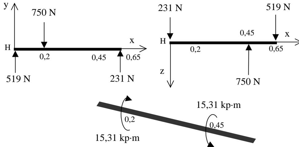
Figura 14.3b Estado de carga desglosado por planos
