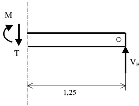
Figura 2.3c Método de las Secciones
