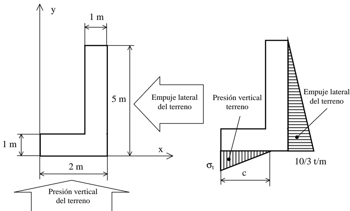
Figura 10.6a Muro con zapata corrida.
