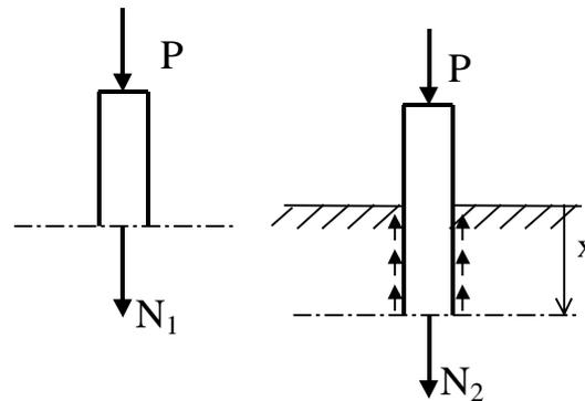
Figura 6.2b Método de las secciones
