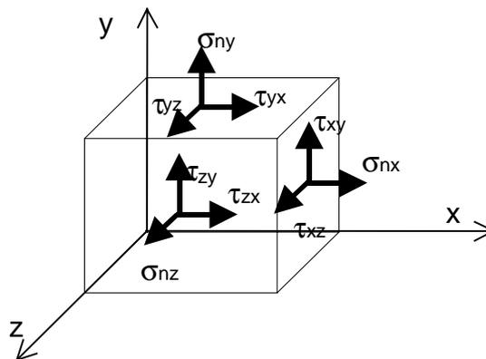
Figura 15.15 Tensión tridimensional, sólo se muestran las tensiones en las caras vistas
