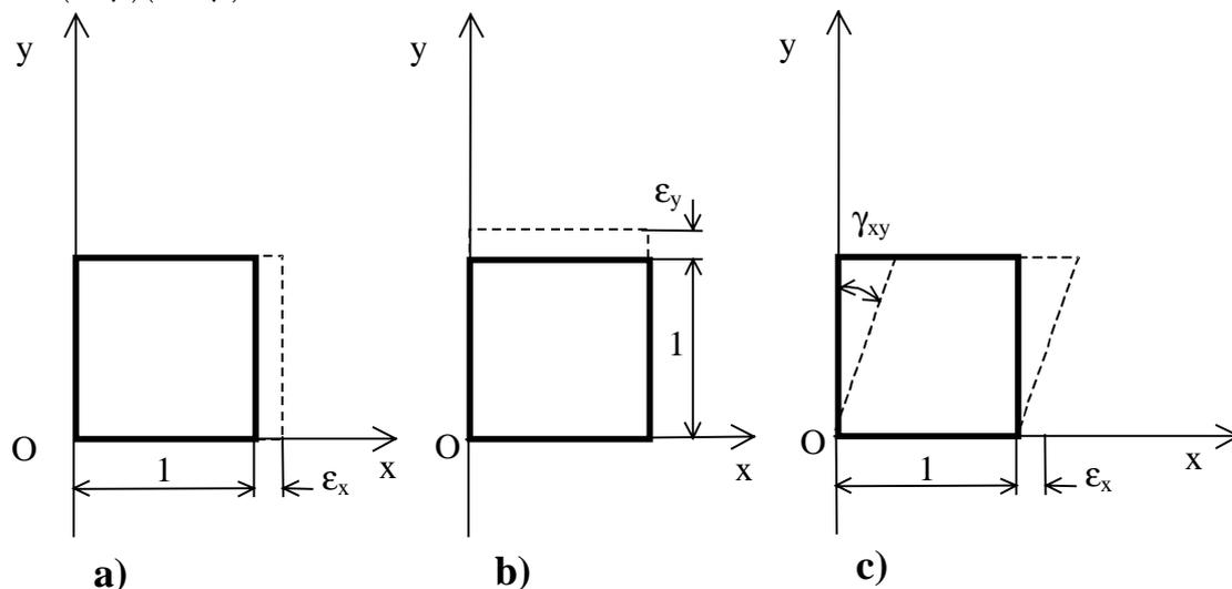
Figura 15.16 Deformaciones en el plano  $\varepsilon_x, \varepsilon_y, \gamma_{xy}$
