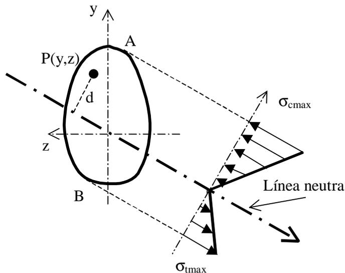
Figura 1 Tensiones a partir de la línea neutra en flexión desviada
