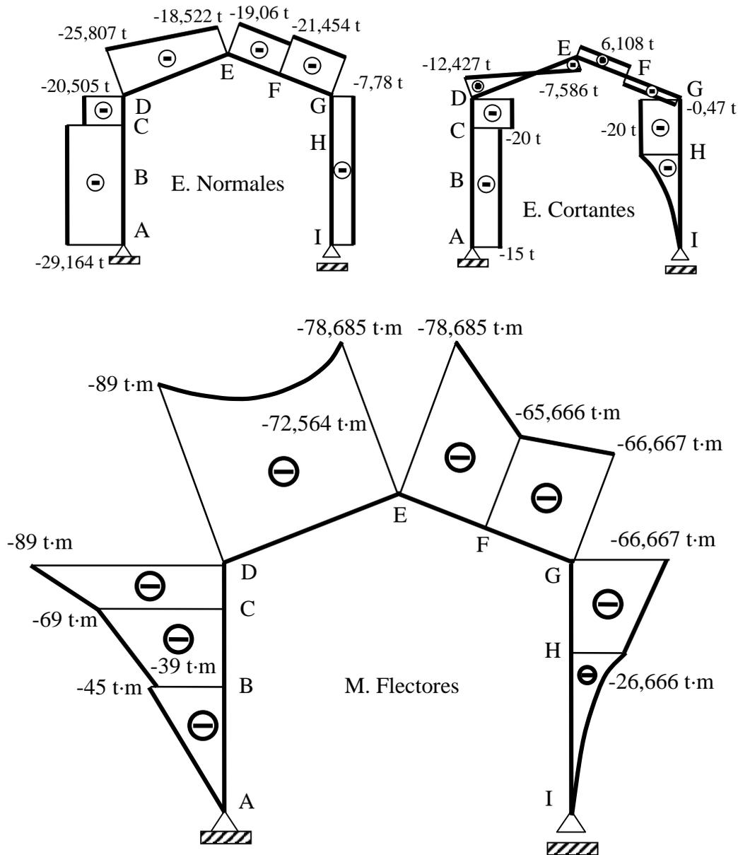
Figura 13.2d.- Diagramas de esfuerzos
