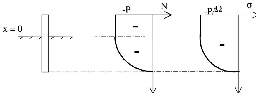
Figura 6.2c. Diagramas de esfuerzos y tensiones normales
