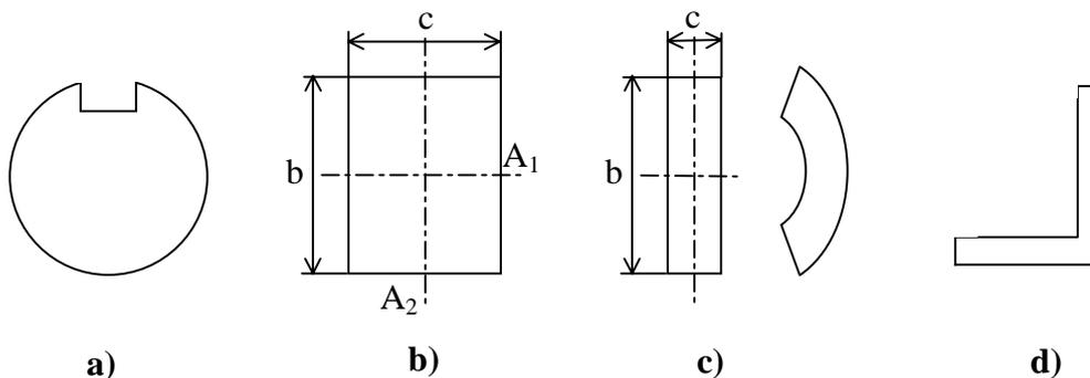
Figura 14.3 Distintas secciones de barras que soportan torsión
