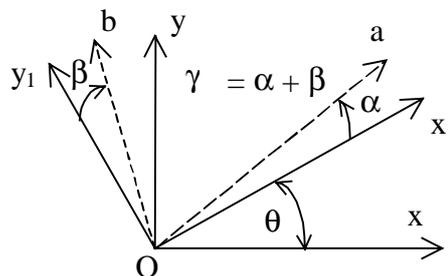
Figura 15.18 Deformación angular  $\gamma$
