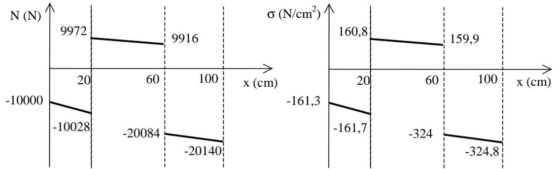
Figura 6.3c Diagramas de esfuerzos y tensiones normales
