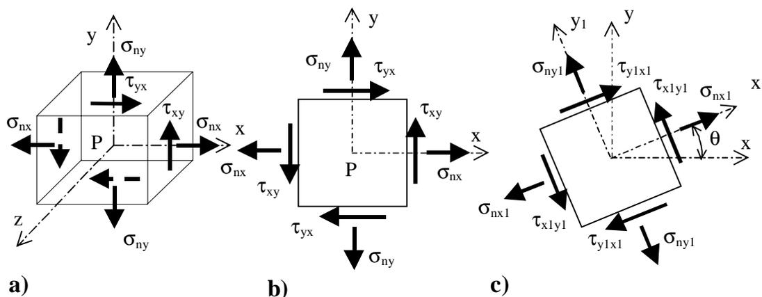
Figura 15.2 Elementos en tensión plana
