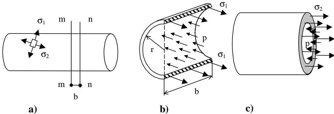
Figura 15.11 Tensiones en un recipiente cilíndrico circular sometido a presión
