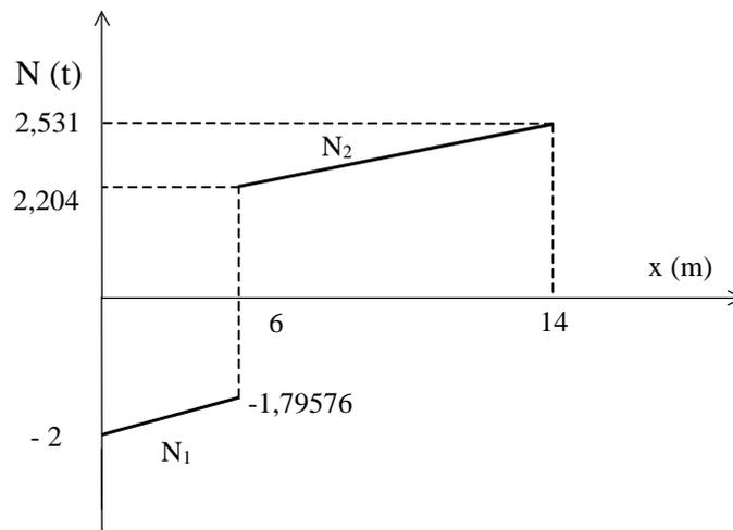
Figura 6.7c Diagrama de esfuerzos normales
