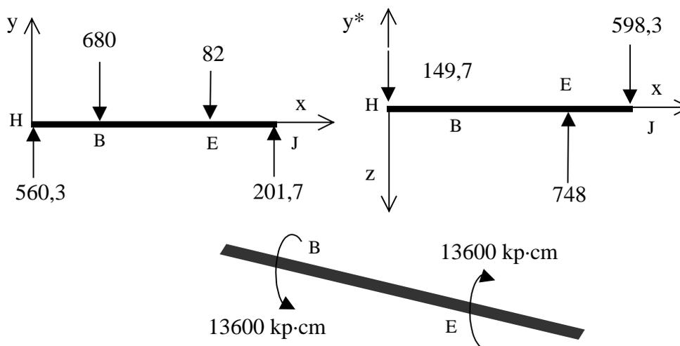
Figura 14.2c Diagrama de cargas por planos
