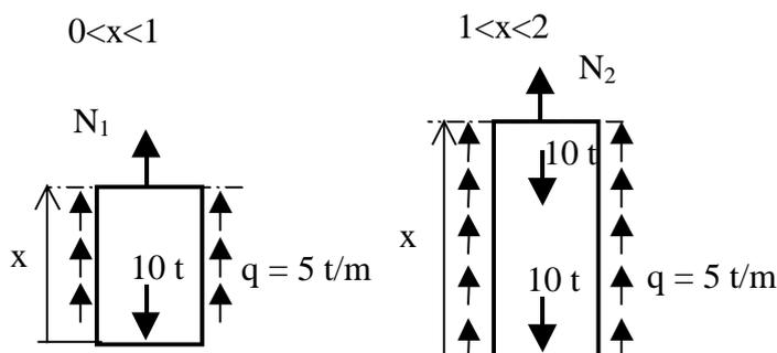
Figura 6.4b Método de las secciones
