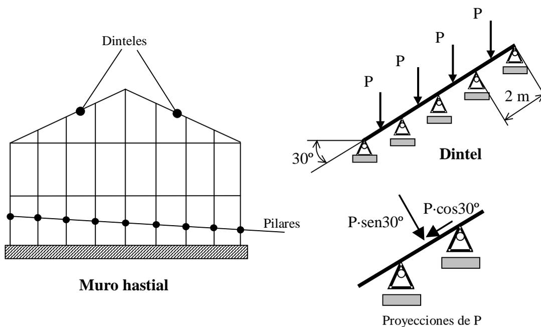
Figura 10.4 Dintel con cargas puntuales en los vanos produciendo flexión compuesta
