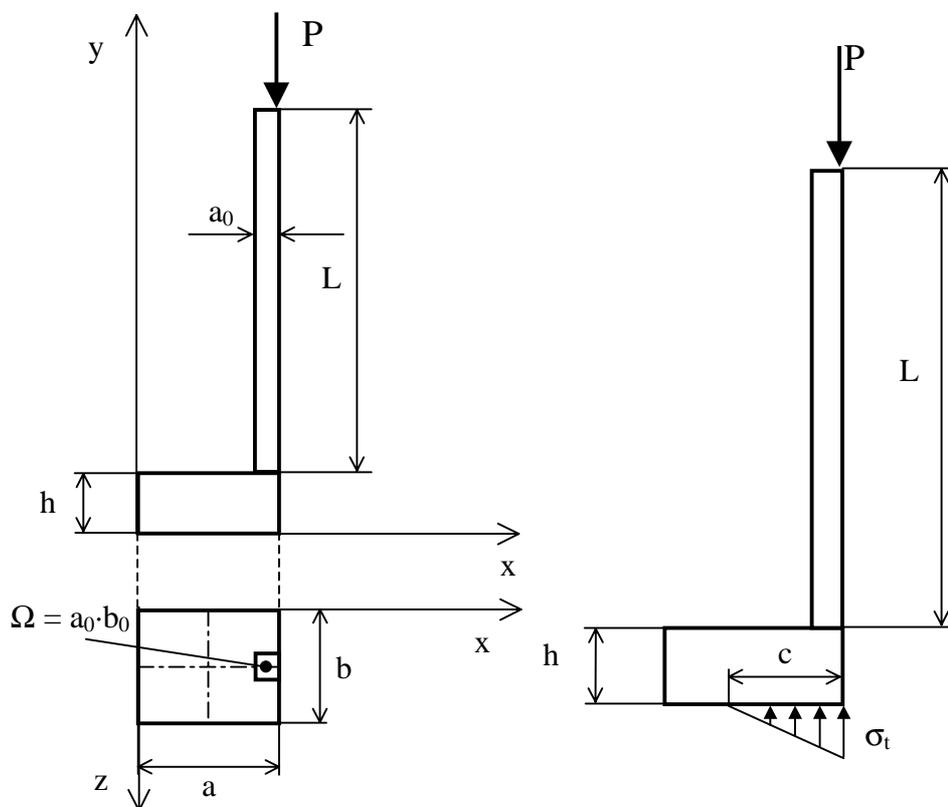
Figura 10.5a Pieza compuesta de pilar y zapata excéntricos
