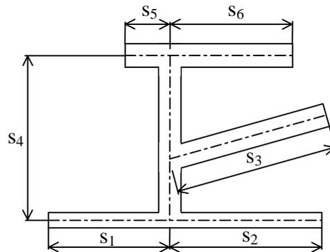
Figura 14.8 Sección abierta ramificada
