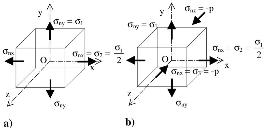
Figura 15.12 Tensiones en un recipiente cilíndrico circular a) en la superficie exterior, b) en la superficie interior
