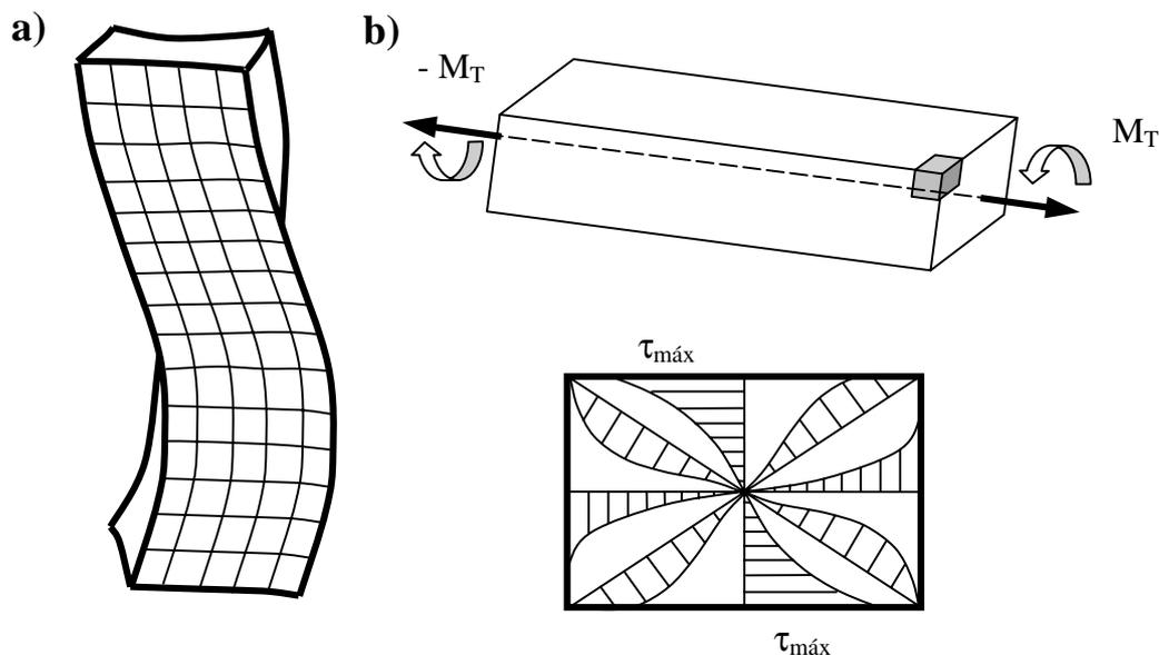
Figura 14.2 Torsión no circular en secciones no circulares. Barra de sección rectangular
