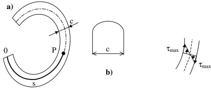
Figura 14.7 Sección abierta sin ramificar
