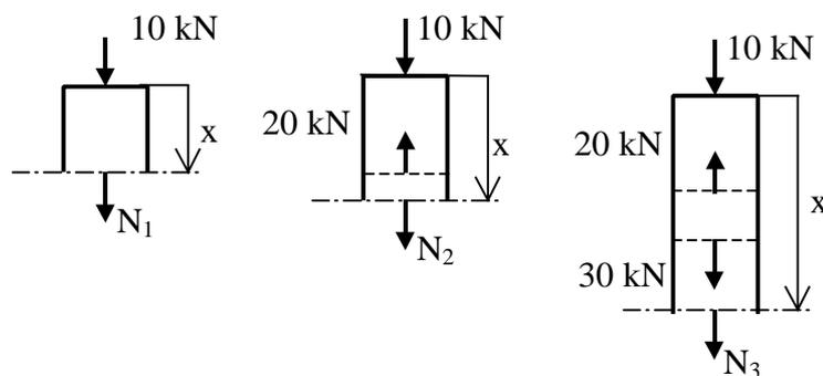
Figura 6.3b Método de las secciones
