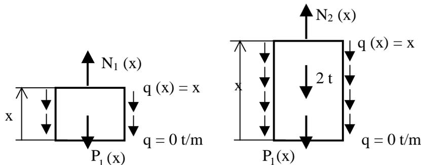
Figura 6.1c Método de las secciones
