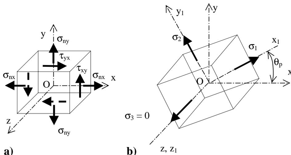
Figura 15.4 Planos principales para un elemento en tensión plana
