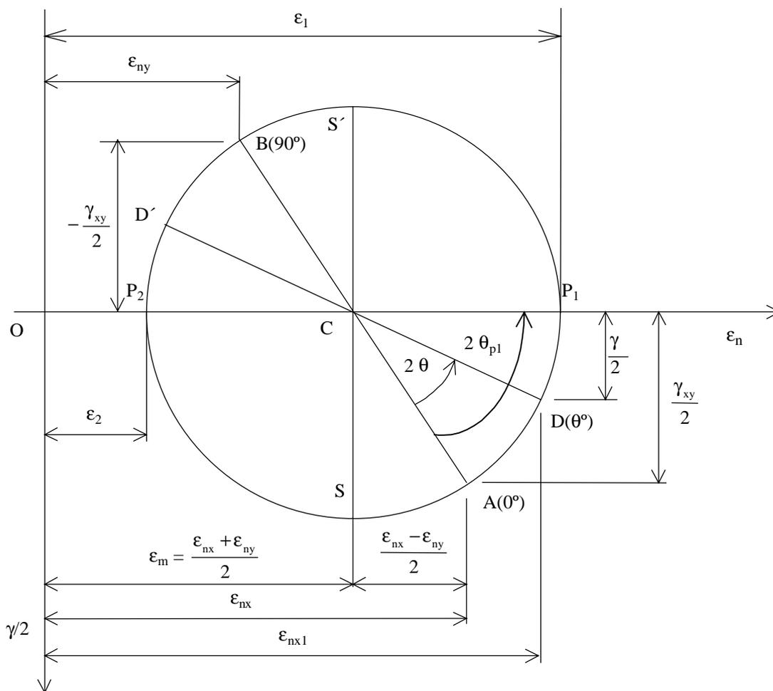
Figura 15.19.- Círculo de Mohr para deformación plana
