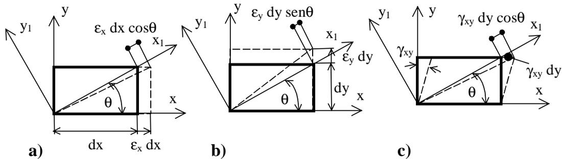
Figura 15.17 Deformación plana a)  $\varepsilon_x$ , b)  $\varepsilon_y$ , c)  $\gamma_{xy}$
