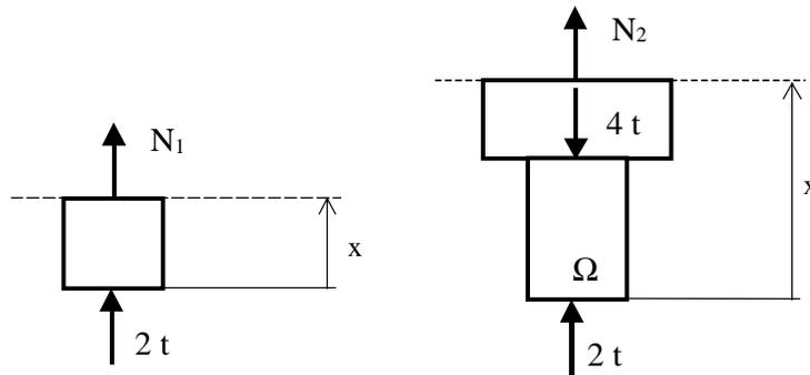
Figura 6.7b Método de las secciones
