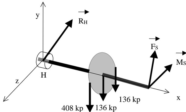
Figura 2.6c Método de las secciones
