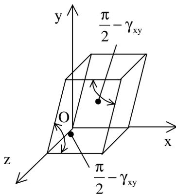
Figura 15.7 Deformación angular  $\gamma_{xy}$
