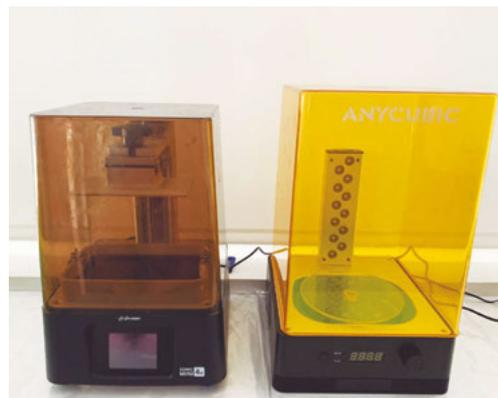
Figura 3. Sistema de impresora 3D «in-house» que permite imprimir en la misma clínica dental las férulas quirúrgicas.
