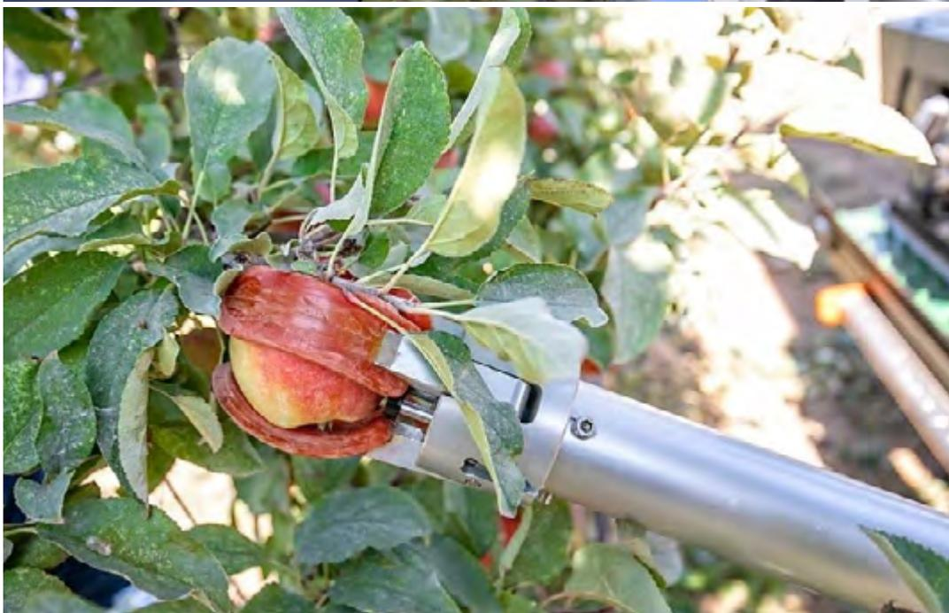
**Figura 3.** Superior detalle de la pinza y del brazo de FFRobot para la recolección automatizada de manzana en sustitución de la mano y del brazo humano (inferior, Foto: I. Iglesias).
