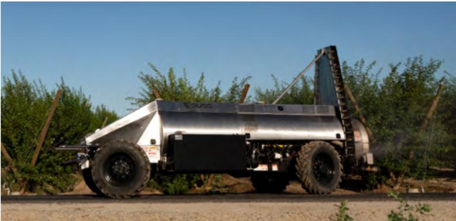
Vista lateral del pulverizador autónomo Mini GUSS con una longitud total de 6 m y torre con 44 boquillas.
