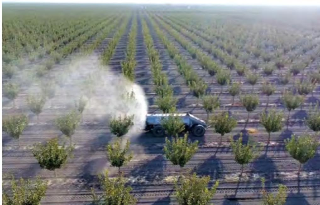
Pulverizador autónomo Mini GUSS con una anchura de 1,8 m está diseñado para plantaciones intensivas de frutales, olivo y viñedo. Su autonomía es de 12 h.
