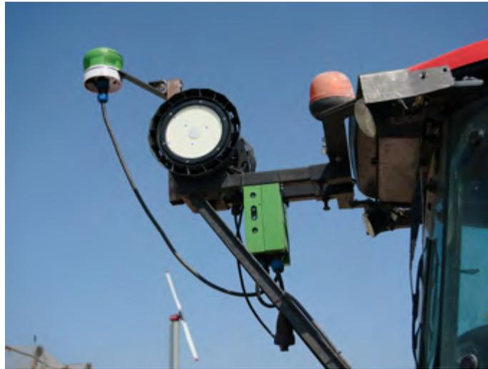
**OnFruit 360:** sensor plug&play, rápido y fácil de instalar, operable por el fruticultor en un vehículo de su flota (tractor u otro).
