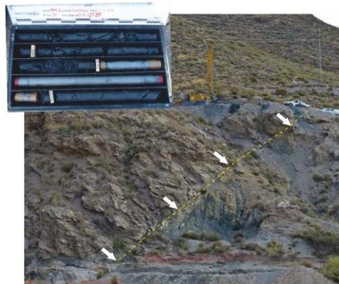
FIGURA 2. Foto de máquina de perforación del sondeo FAM-1. Las flechas marcan el contacto entre protolito y fault gouge. A la izquierda detalle de una de las cajas de testigos extraídos.
