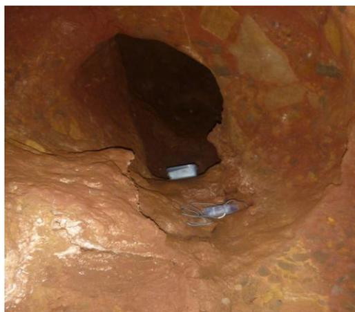
FIGURA 3. Detalle de sensores instalados en Sima del Vapor. Sensor de temperatura HOBO de dos canales (Temp. en roca y Temp ambiente) y sensor de  $\text{CO}_2$  de tipo SENS AIR al 1% con 30 ppm de resolución. Colocados a -30m, registran un dato cada 20 minutos
