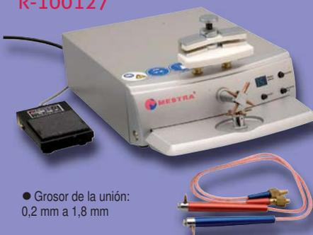
La máquina está controlada electrónicamente, lo que prácticamente elimina las chispas que normalmente se producen entre electrodos en las máquinas sin regulación. La potencia puede seleccionarse entre 30 niveles diferentes para adecuarse a los requerimientos de espesor del material que se desea soldar.
