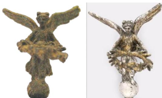
Fig. 2. Resultados de la limpieza láser de un alfiler romano dorado en plata. Adaptada de [9].
