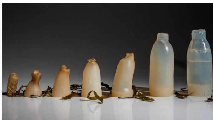
Fig. 3. Proceso de descomposición (de derecha a izquierda) de una botella fabricada con agar.
