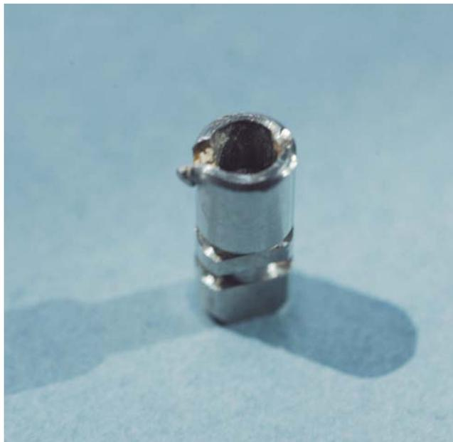
Figura 1. La reutilización de los componentes protésicos es una causa de distorsión en los ajustes y mala ubicación de los pilares y prótesis definitivas.
