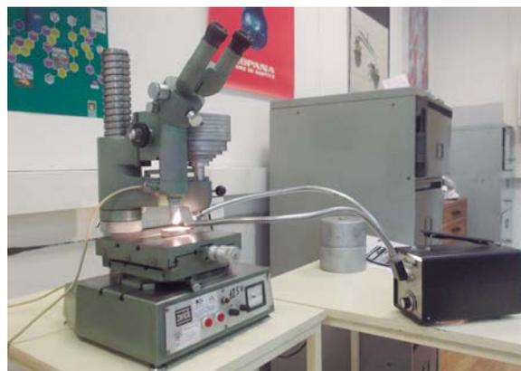
Figura 3. Durómetro marca Zwick para determinación de Dureza tipo Vickers.
