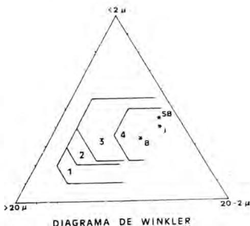
Figura 6. Diagrama de Winkler, para clasificación de la vocación cerámica de las materias primas en función de su granulometría. 1: ladrillo macizo; 2: ladrillo hueco; 3: tejas y placas; 4: piezas de gran formato (bovedillas, hurdís, etc.). SB: Santa Bárbara; J: Jaulín; B: Butano.
