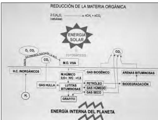
Figura 7. Síntesis de los diferentes combustibles fósiles y relación entre ellos. Los “hidratos de metano” se podrían formar en conexión con el “gas biagénico, en climas fríos o en zonas profundas del océano (también a temperaturas de pocos grados sobre 0° C).
