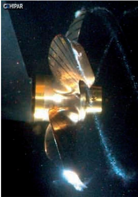
Figura 7. Ensayo de cavitación.
