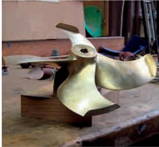
Figura 4. Hélice CLT.
