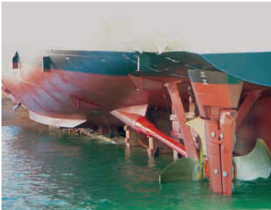
Figura 8. CLT Instalada en el BAM.
