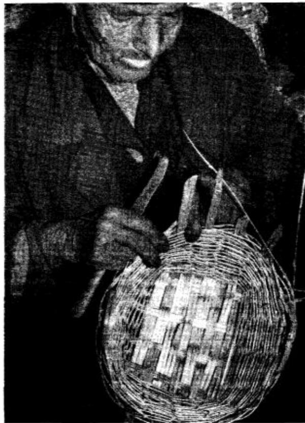
FIG. 10.—“Virando una punta”. A la derecha y a la izquierda se han formado ya dos asas
