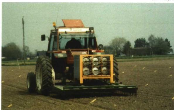
Foto 2: Desherbador de gran superficie utilizado sobre un cultivo de lenta germinación como la remolacha. En este caso se genera una serie de llamas en toda la superficie bajo el chasis verde que actúan de forma directa sobre las hierbas
