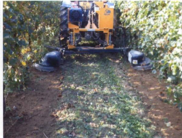
Foto 6: Modelo de intercepas en viña con posibilidad de trabajar dos filas al mismo tiempo mediante cuchillas desbrozadoras (modelo Tournesol) diseñada para viñas emparradas.
