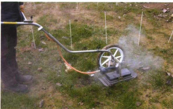
Foto 1: Termodesherbador manual con placa calefactora calentada con gas propano que distribuye el calor indirectamente mediante rayos infrarrojos.
