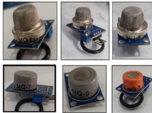
Figura 9. Sensores MQ 2, MQ 3, MQ 6, MQ 7, MQ 9 y MQ 135. Fuente Autores.
