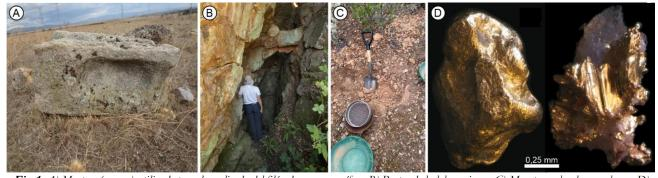
Fig 1. A) Mortero (caraza) utilizado para la molienda del filón de cuarzo aurífero. B) Restos de la labor minera. C) Muestreo sobre la escombrera. D) Ejemplo del oro recuperado. Izq.: partícula liberada del cuarzo. Drcha.: oro con restos de cuarzo filoniano.
