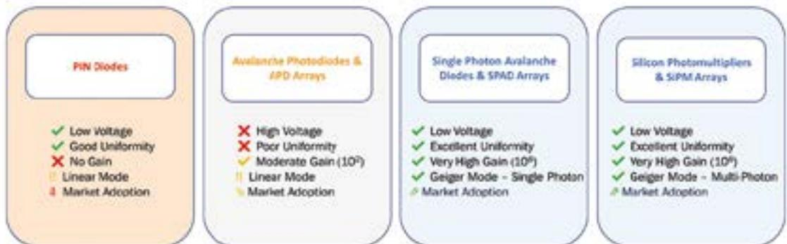
Figura 4. Diferentes tipos de fotodetectores utilizados para detectar señales en un LiDAR.
