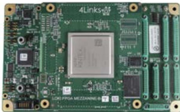
Figura 1. La plataforma de desarrollo Loki de 4Links (con el área de conexión del subsistema a la derecha).
