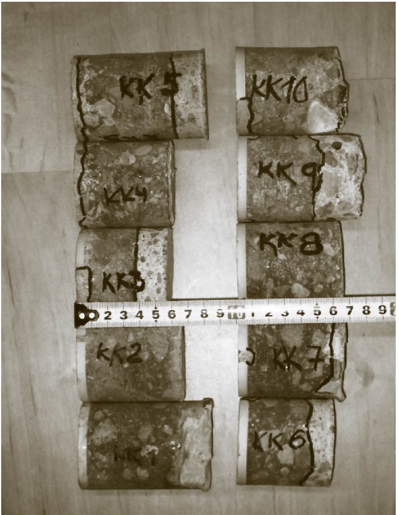
Pruebas de carbonatación en muestras del edificio donante finlandés. La carbonatación juega un papel importante en la corrosión del refuerzo y, por lo tanto, es un buen predictor para la vida útil restante de un edificio de hormigón. / Carbonation tests on samples from the Finish donor building. Carbonation plays an important role in the corrosion of the reinforcement and is therefore a good predictor for the remaining service life of a concrete building.
