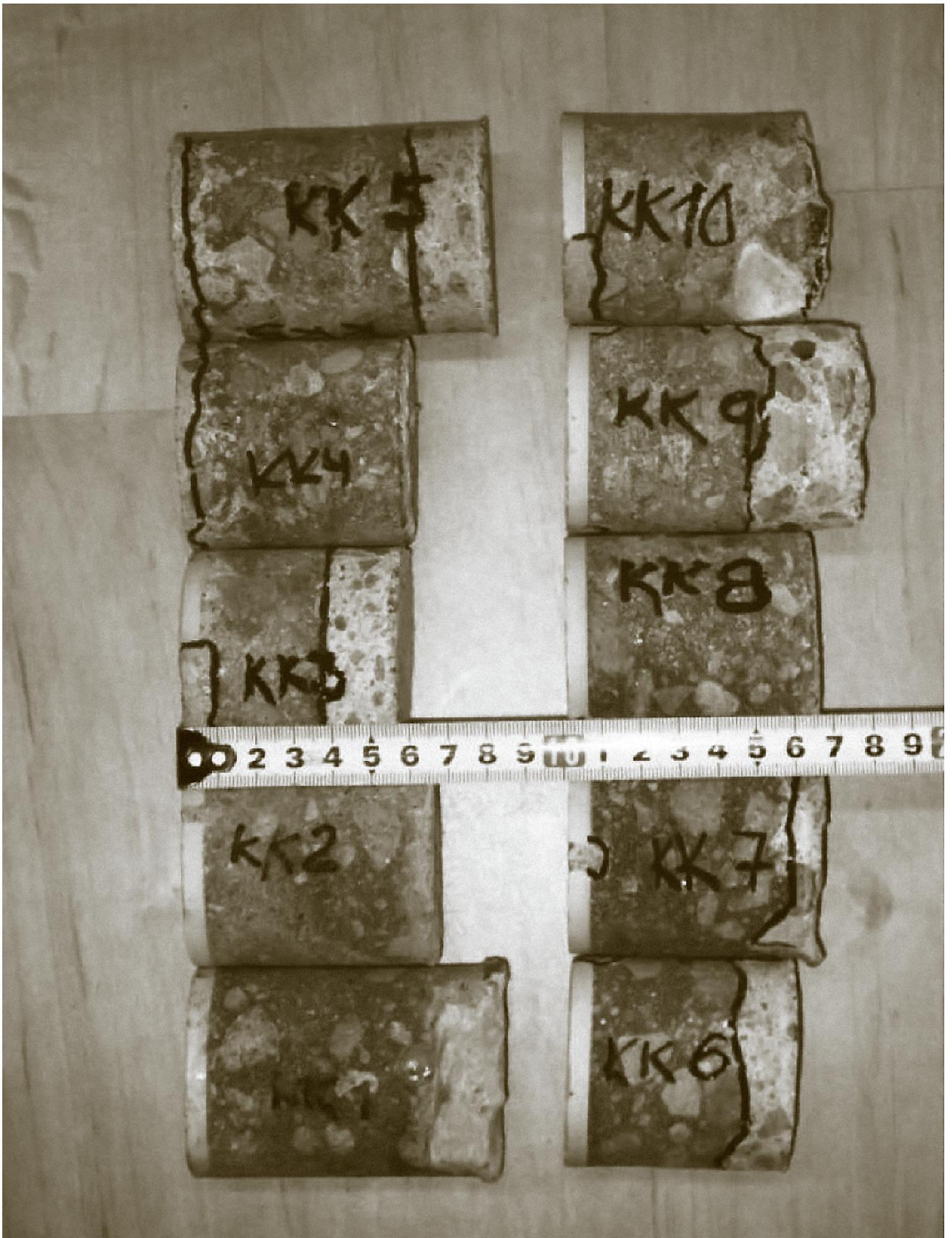
Pruebas de carbonatación en muestras del edificio donante finlandés. La carbonatación juega un papel importante en la corrosión del refuerzo y, por lo tanto, es un buen predictor para la vida útil restante de un edificio de hormigón. / Carbonation tests on samples from the Finnish donor building. Carbonation plays an important role in the corrosion of the reinforcement and is therefore a good predictor for the remaining service life of a concrete building.
