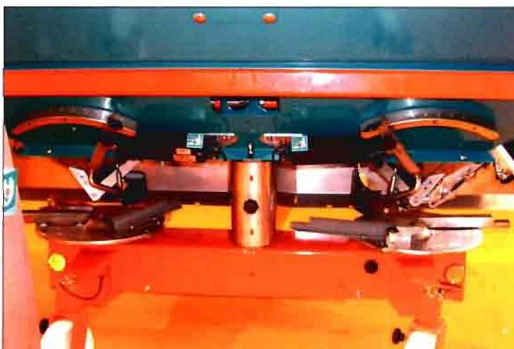
Foto 4. Dispositivos del sistema electrónico para la variación de caudales.
