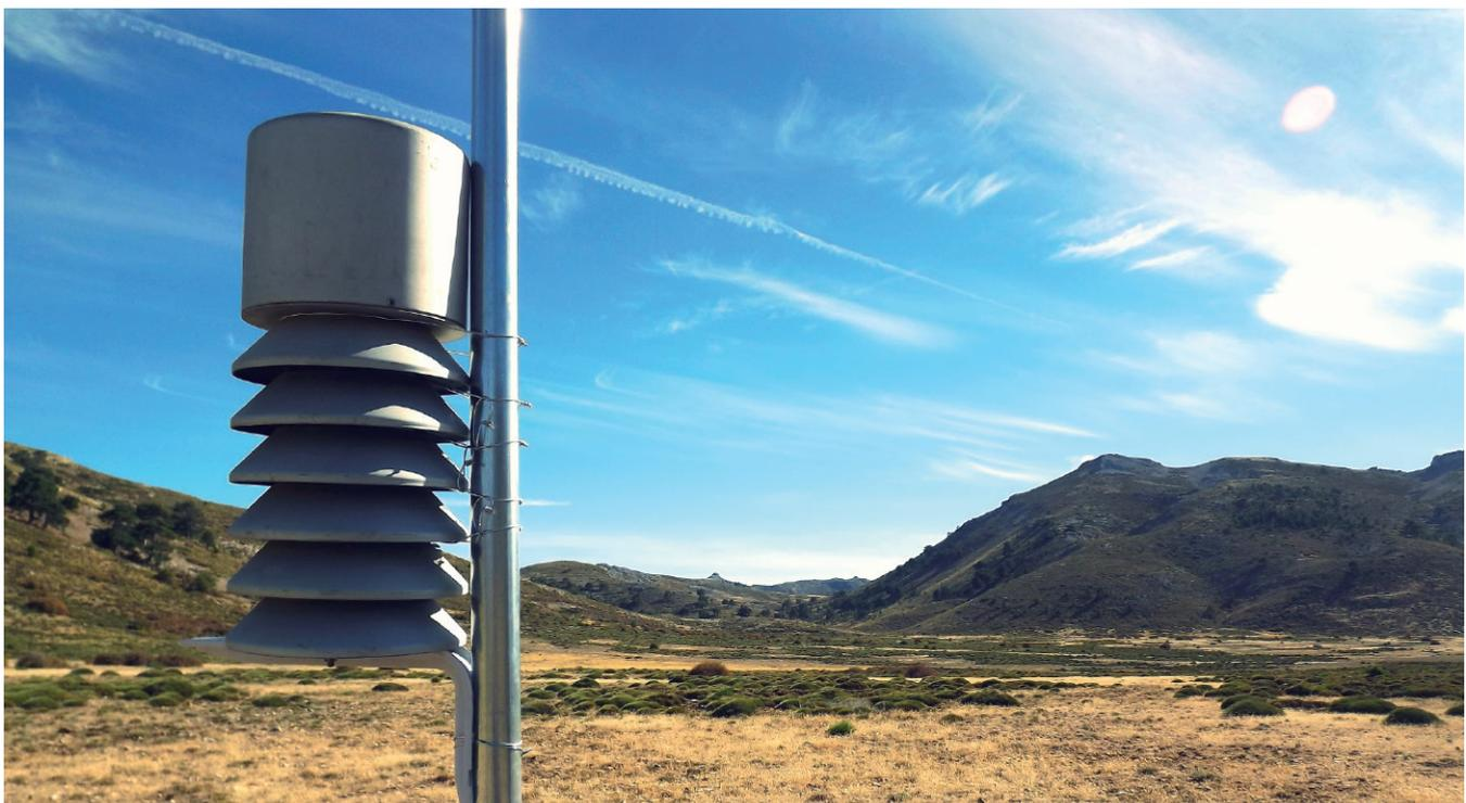
**Imagen 1.** Sensor térmico (datalogger) localizado en el polje colgado de Navalaso (Jaén), a una altitud de 1770 m. Garita meteorológica de tipo Pagoda, cedida por AEMET Murcia, con sensor microlite 32K en su interior. Fuente: Autor.
