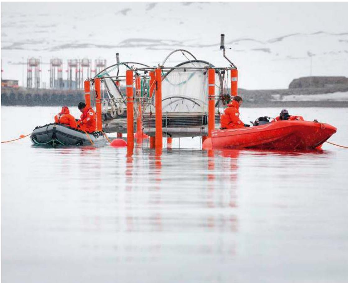
Los estudios con radiotrazadores pueden realizarse en estructuras de tiendas flotantes o en el fondo marino denominadas mesocosmos. Este valioso instrumento experimental permite que se estudien entornos naturales en condiciones controladas combinando las ventajas del laboratorio y del trabajo sobre el terreno.
