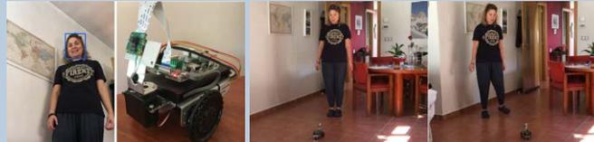
Figura 5: Comportamiento sigue-persona mediante visión
