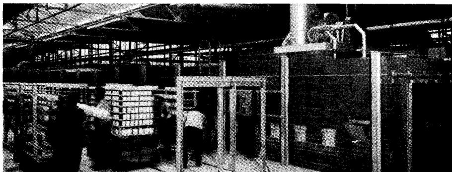
Horno túnel. Típico
