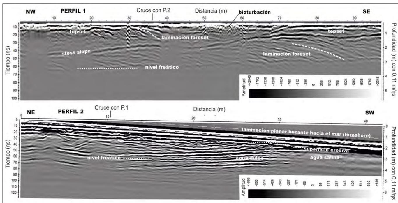
Fig. 3.- Radargramas con antena de 250 MHz, paralelo (perfil 1) y perpendicular a la línea de costa (perfil 2).
