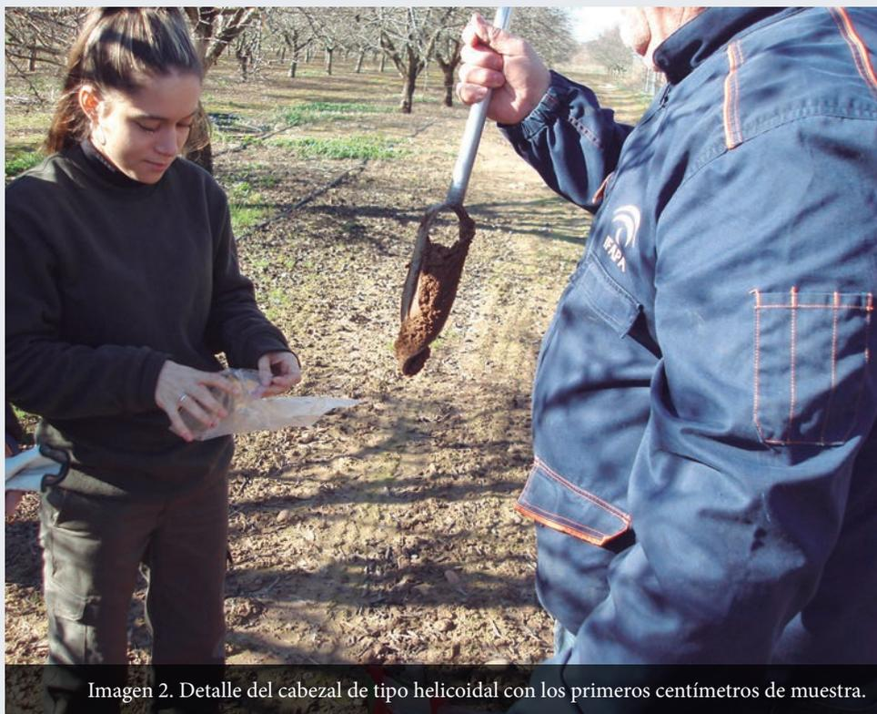
Imagen 2. Detalle del cabezal de tipo helicoidal con los primeros centímetros de muestra.
