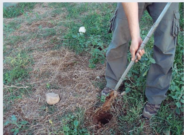
Imagen 1. Vista de la extracción de una muestra de suelos con la barrena.
