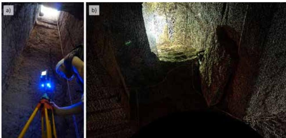
Figura 176. Ejemplo de escaneo en interiores: a) Pozo de QH34aa; b) nube de puntos resultante de escaneo en QH32.
