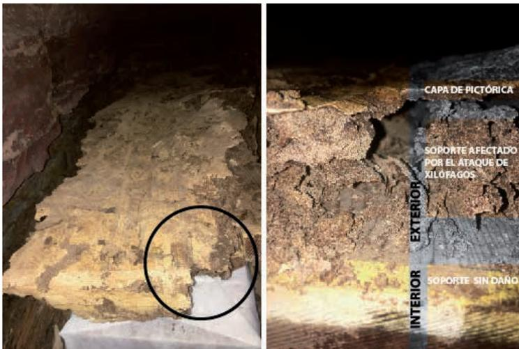
Figura 102. Sección de los distintos estados en los soportes.
