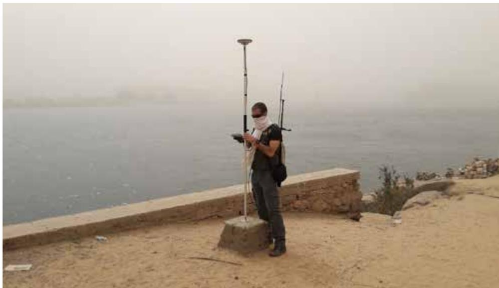
Figura 168. Equipo móvil GNSS Leica GPS1203+.
