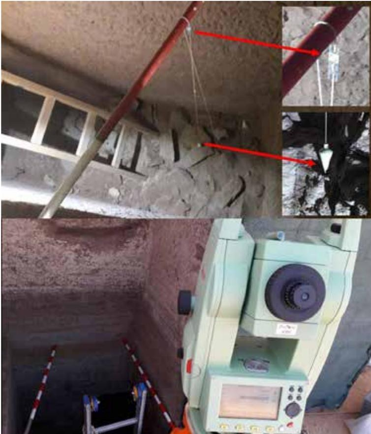
Figura 170. Procedimiento para trasladar el sistema de referencia en pozos, basado en plomada y placa de puntería situada en la parte superior de la cuerda.
