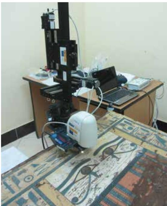
Figura 144. Microespectrómetro Raman portátil.
