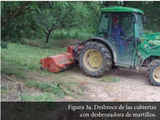
Figura 3a. Desbroce de las cubiertas con desbrozadora de martillos.
