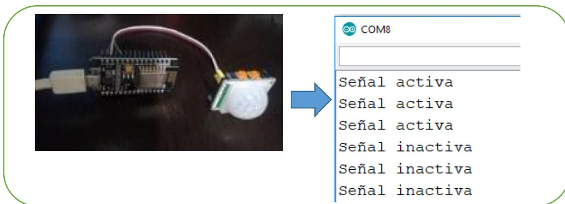
Fig. 12: Resultados sensor de movimiento piroelectrico HC-SR501- Señal Inactiva y activa.
