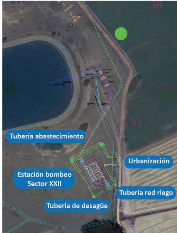
Figura 2. Solución proyectada para la distribución de agua.
