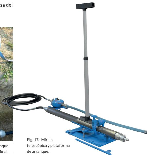
Fig. 17.- Mirilla telescópica y plataforma de arranque.
