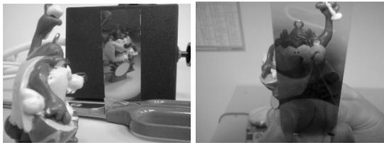
Fig.4.- Comparación entre las láminas sin hidrogenar a) y las láminas hidrogenadas b).
