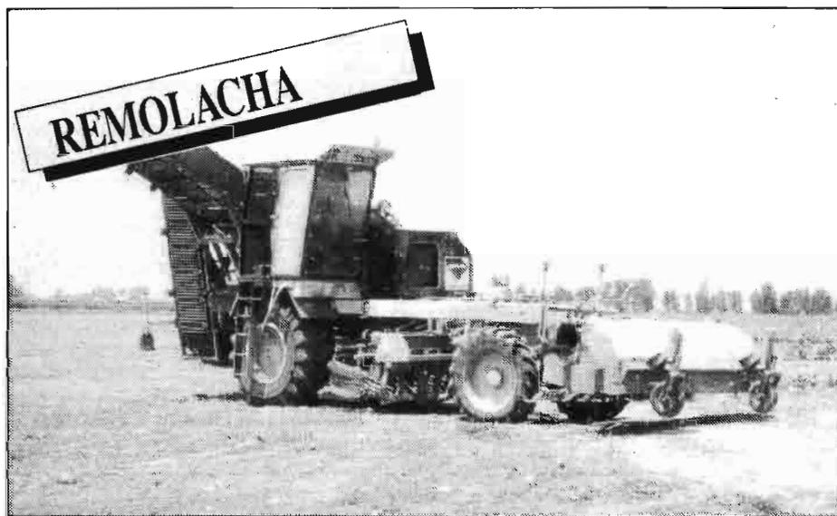
La recolección mecanizada de la remolacha solo se puede conseguir, además de una siembra de precisión, con máquinas apropiadas y reguladas según las condiciones del cultivo. (Plan 92).
