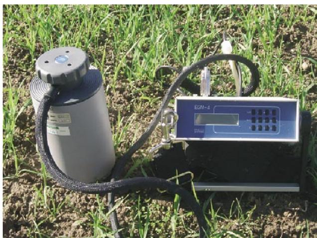
Figura 1. Esquema de la unidad experimental con los puntos de muestreo y fotografía del dispositivo de medida del flujo de gas.
