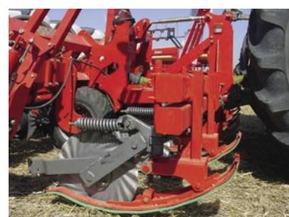
piedras u obstáculos diversos en el suelo, se requiere reducir la velocidad de siembra para no dañar a la sembradora. En dichas situaciones, los elementos rodantes de la sembradora pasan por encima de las piedras u obstáculos, si bien esto causa que se pierda el control de la profundidad de siembra. La teoría aconseja el empleo de máquinas de rejas, si bien pueden hacer aflorar piedras superficiales de tamaño considerable.
