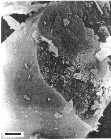
Figura 7. Micrografía de MEB de geles secos de la muestra B (120 °C/ 24 horas); barra = 5  $\mu$ m.
