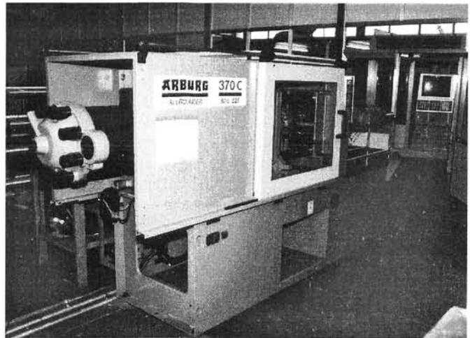
Figura 3 - Máquina de Moldeo por Inyección.
