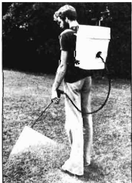
Aplicación de herbicida con pulverizador hidráulico de mochila.
