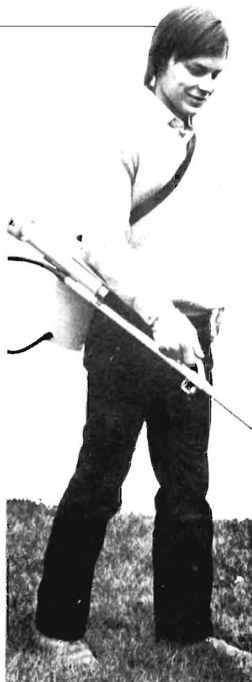
Pulverizador centrífugo para aplicación de herbicidas
