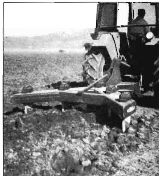
El subsolador se utiliza en labores de reestructuración del suelo y para romper la suela de labor (Doc. Agruiz).
