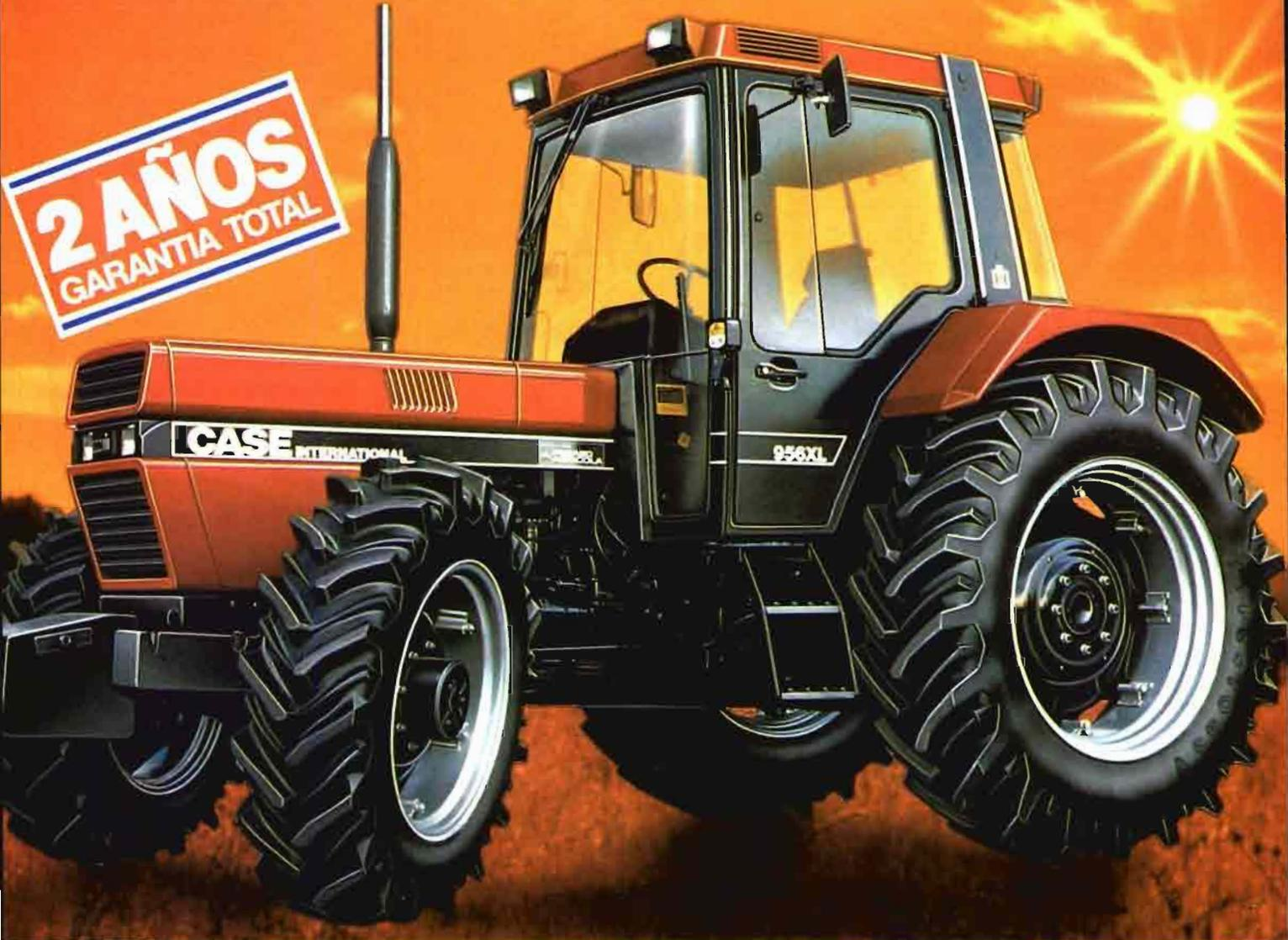
por su nueva línea, excelente giro de ruedas (10°), menor radio de giro, mejor confort de conducción, nuevo puente de dirección delantera con transmisión central, autoblocante, mando pulsador (electrohidráulico), embrague en marcha y bajo carga,
