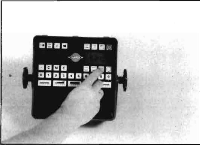
*Hardi Tronic 1800 es un sistema de control electrónico del pulverizador, que facilita las siguientes informaciones: —l/Ha. —Km/h —Superficie trabajada. —Volumen de líquido. —Ancho de trabajo. —Presión (opcional). —l/min. —Reloj. —Vaciaciones en %. El HARDI TRONIC puede también utilizarse en otros equipos como sembradoras, distribuidoras de abono, etc.*
