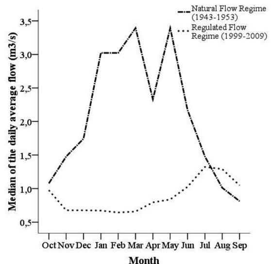
**Figure 2.** Medians of the mean daily flow by months, calculated at the gauging station at Lorcha (downstream of the Beniarrés dam) under natural conditions (1943-1953) and after dam construction (1999-2009) for the Serpis River, East Spain. *Medianas del caudal medio diario por meses, calculado en la estación de aforo de Lorcha (aguas abajo del embalse de Beniarrés) bajo condiciones naturales (1943-1953) y tras la construcción de la presa (1999-2009) para el río Serpis, España.*
