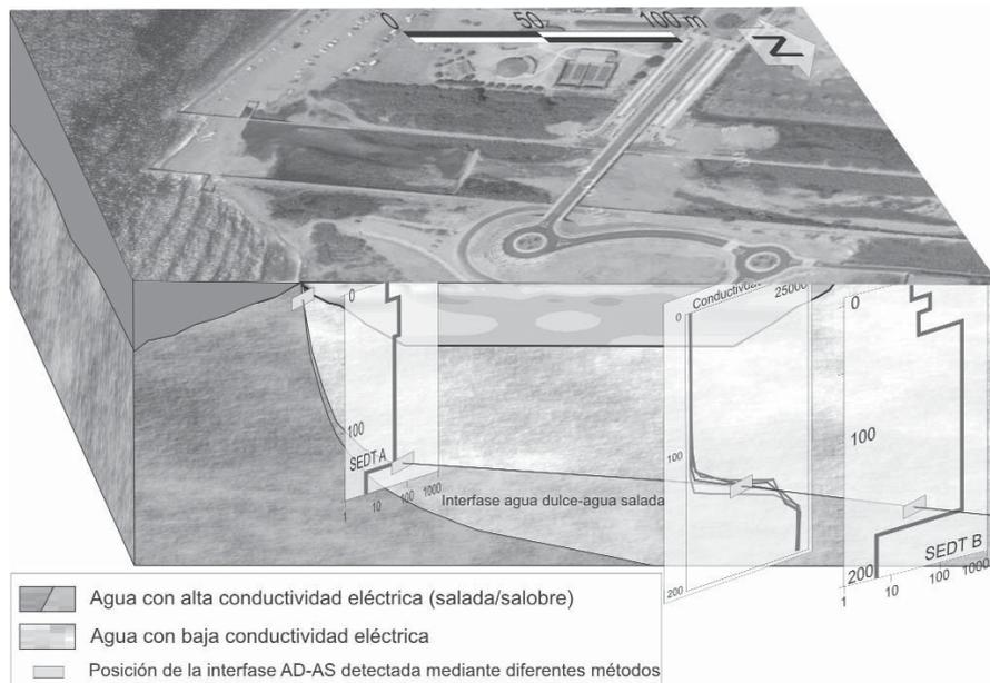
**Fig. 3.- Contacto agua dulce-agua salobre obtenido a partir de las diferentes metodologías.**
