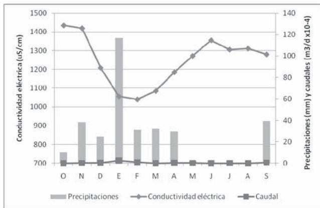
Fig. 5. Variaciones de conductividad eléctrica. Pozo 21. 2005-2006.
