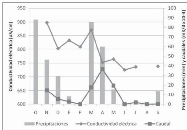
Fig. 6.- Variaciones de conductividad eléctrica. Pozo 7. 2001-2002.
