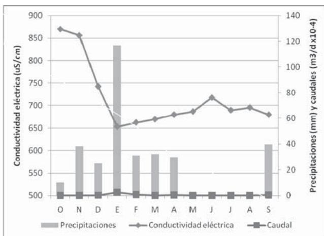
Fig. 7.- Variaciones de conductividad eléctrica. Pozo 7. 2005-2006.
