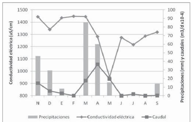
Fig. 4.- Variaciones de conductividad eléctrica. Pozo 21. 2001-2002.
