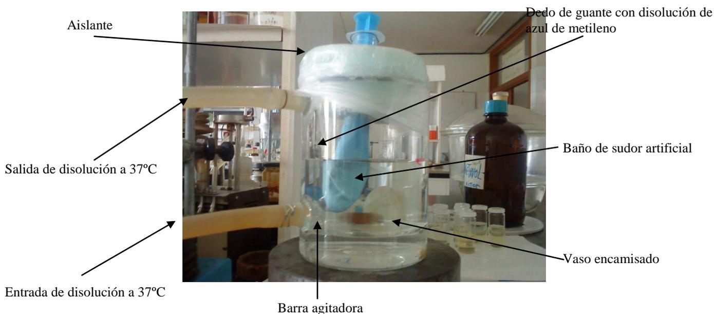
Figura 1. Montaje para el ensayo de permeación.
